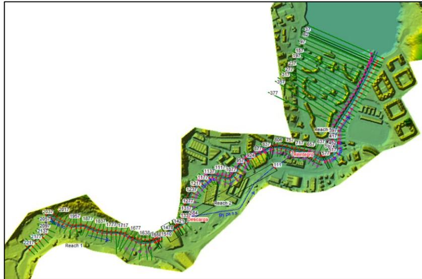
Figura nº 33 Geometría y perfiles transversales del área de estudio incluyendo el canal de derivación. Hec-Ras.
