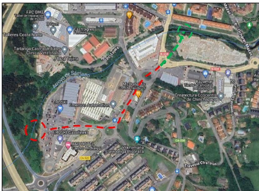
Figura nº 32 Puntos de entrada y salida para el canal de derivación. Trazado bajo tierra (rojo) y a cielo abierto (verde)
