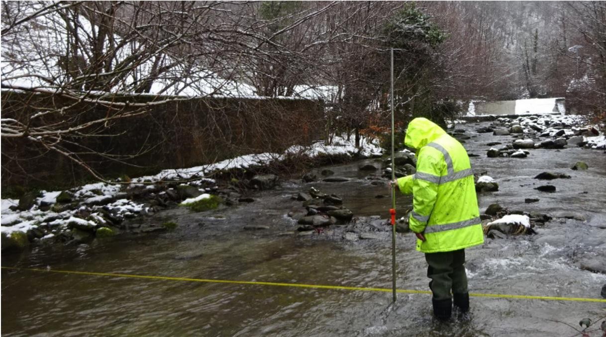
FIGURA CA 6. Aforo por vadeo en el río Negro con equipo de inducción magnética Inspección Salto de Murias
