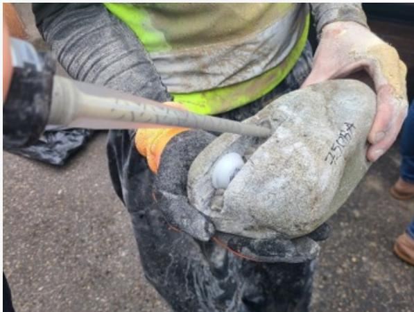
Sellado del hueco con el dispositivo de seguimiento de los arrastres de fondo colocado en el interior del canto rodado.
