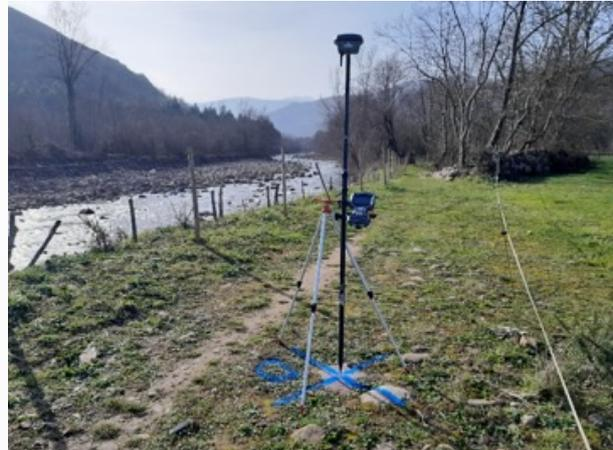
Apoyo vuelo dron con técnicas GPS para la generación de modelo digital del terreno. Selores-Cabuérniga.
