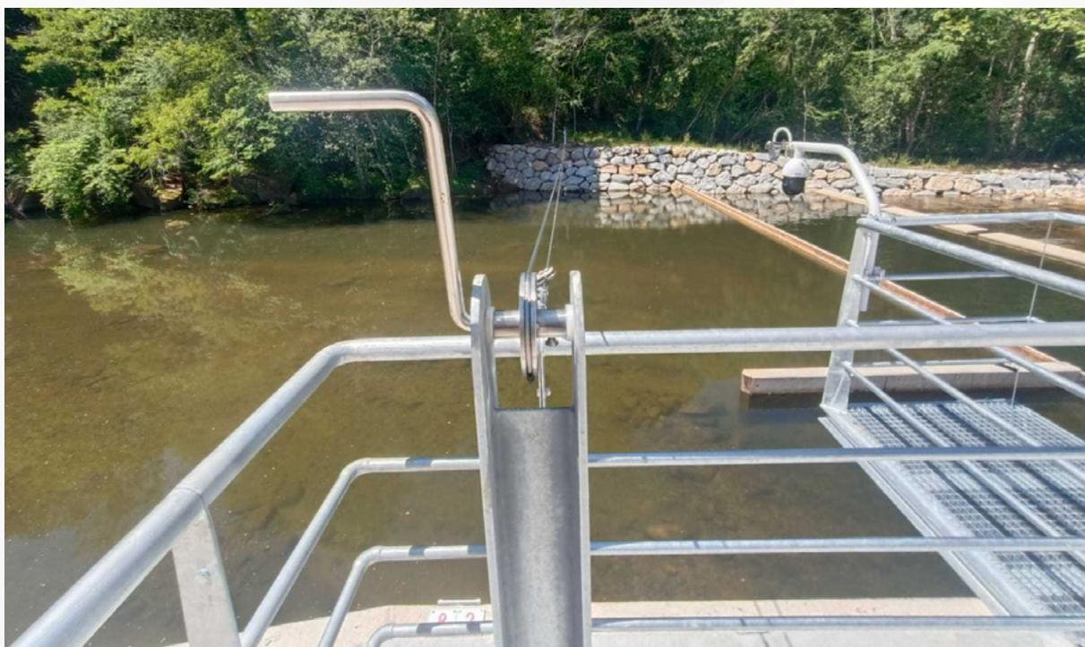
FIGURA CA 9. Estación 1256 del río Nansa en Rábago ☒ dispositivo de aforos
