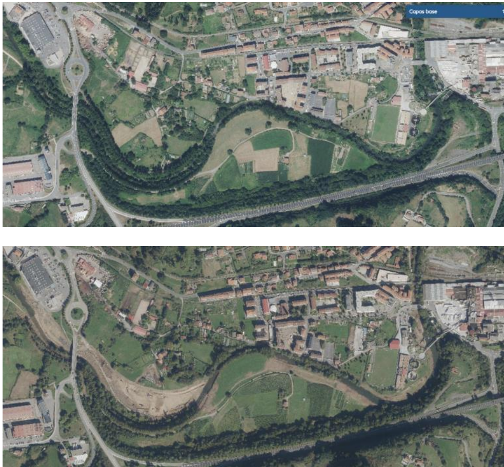
Figura 14. Tramo del río Cadagua objeto de las obras del «Proyecto de defensa contra inundaciones del río Cadagua a su paso por Aranguren en el municipio de Zalla (Bizkaia)». Comparación de la fotografía aérea del año 2023, anterior al inicio de las obras (arriba) y del año 2024, con las obras en marcha (abajo).
