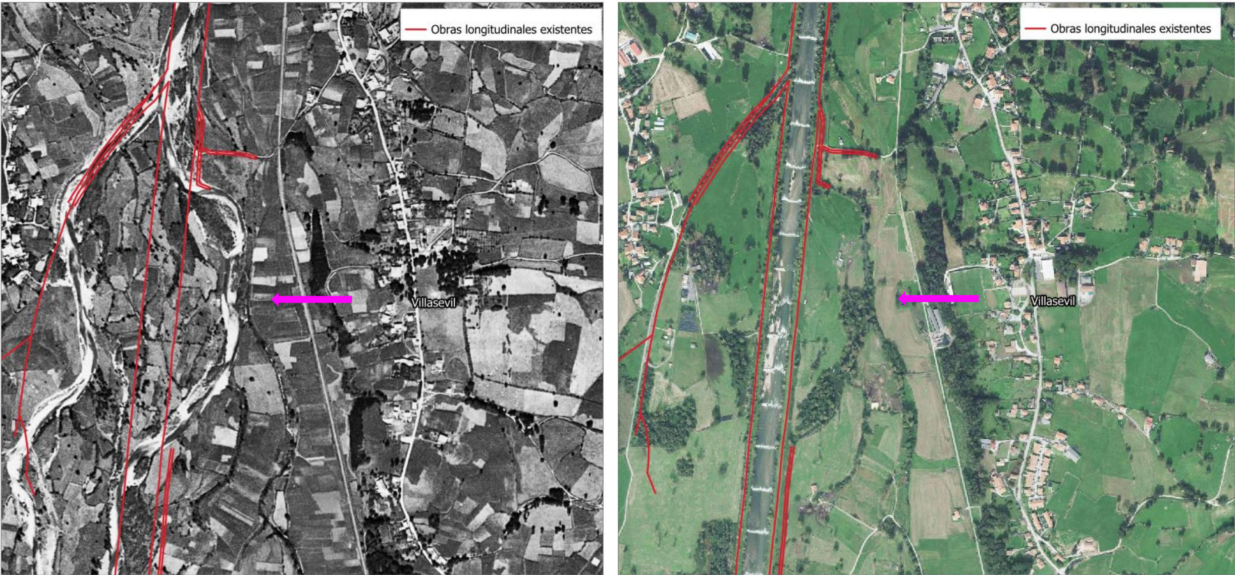
Figura 185. Análisis comparativo entre la situación histórica (1956) y la actual (2020) del río Pas en zona de Villasevil (T.M Santiurde de Toranzo), con obras longitudinales existentes en la actualidad. En la imagen izquierda se observa la sinuosidad antigua del cauce del río Pas.
