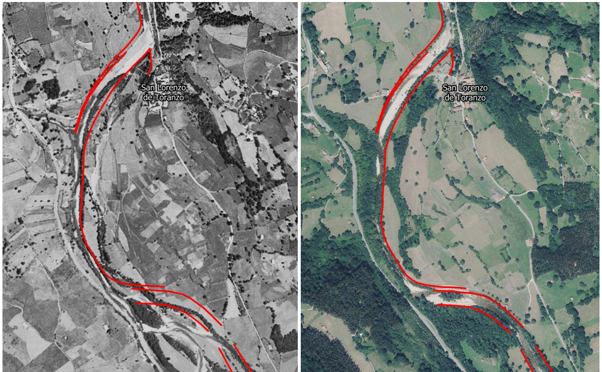
Figura 65. Obras longitudinales del Tramo 1 en el meandro entre Entrambasmestas y San Lorenzo de Toranzo. A la izquierda sobre el Vuelo Americano de 1956 y a la derecha en la situación actual (imagen PNOA 2020).
