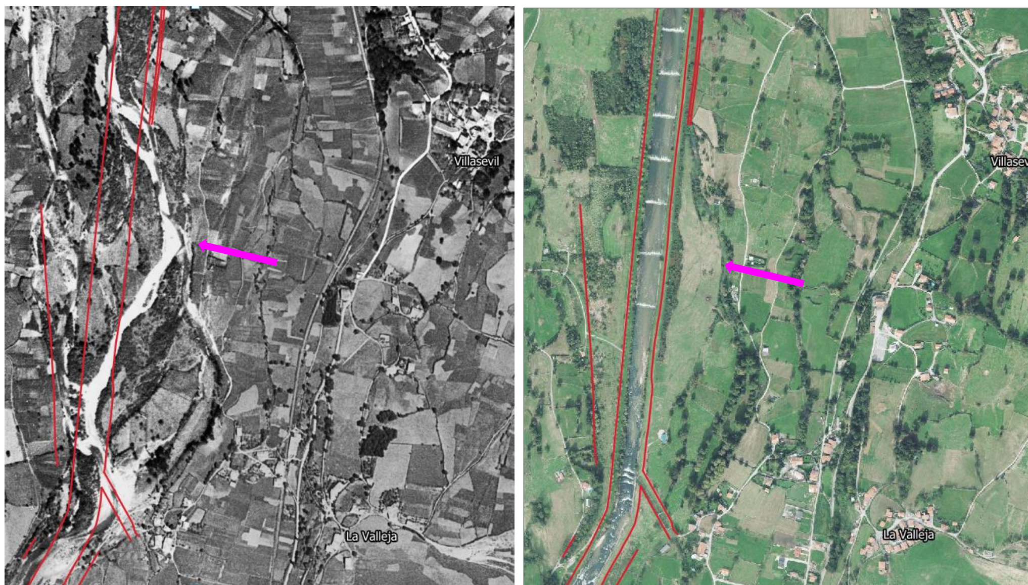
Figura 173. Análisis comparativo entre la situación histórica (1956) y la actual (2020) del río Pas en zona de Villasevil (T.M Santiurde de Toranzo), con obras longitudinales existentes en la actualidad. En la imagen izquierda se observa la sinuosidad antigua del cauce del río Pas.
