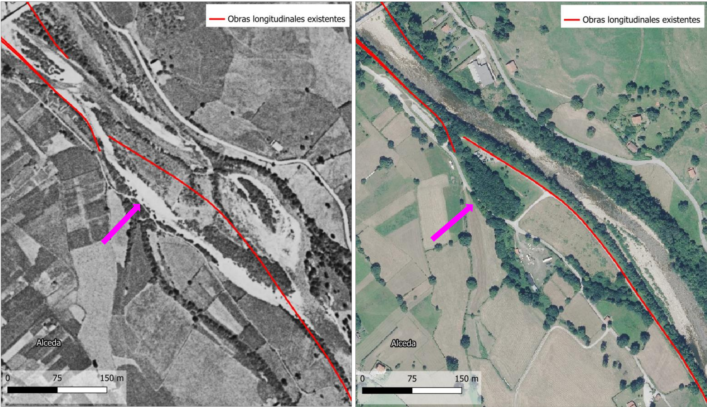
Figura 87. Análisis comparativo entre la situación histórica (1956) y la actual (2020) en zona aguas arriba del Puente Alceda-Vejoris con obras longitudinales existentes en la actualidad.
