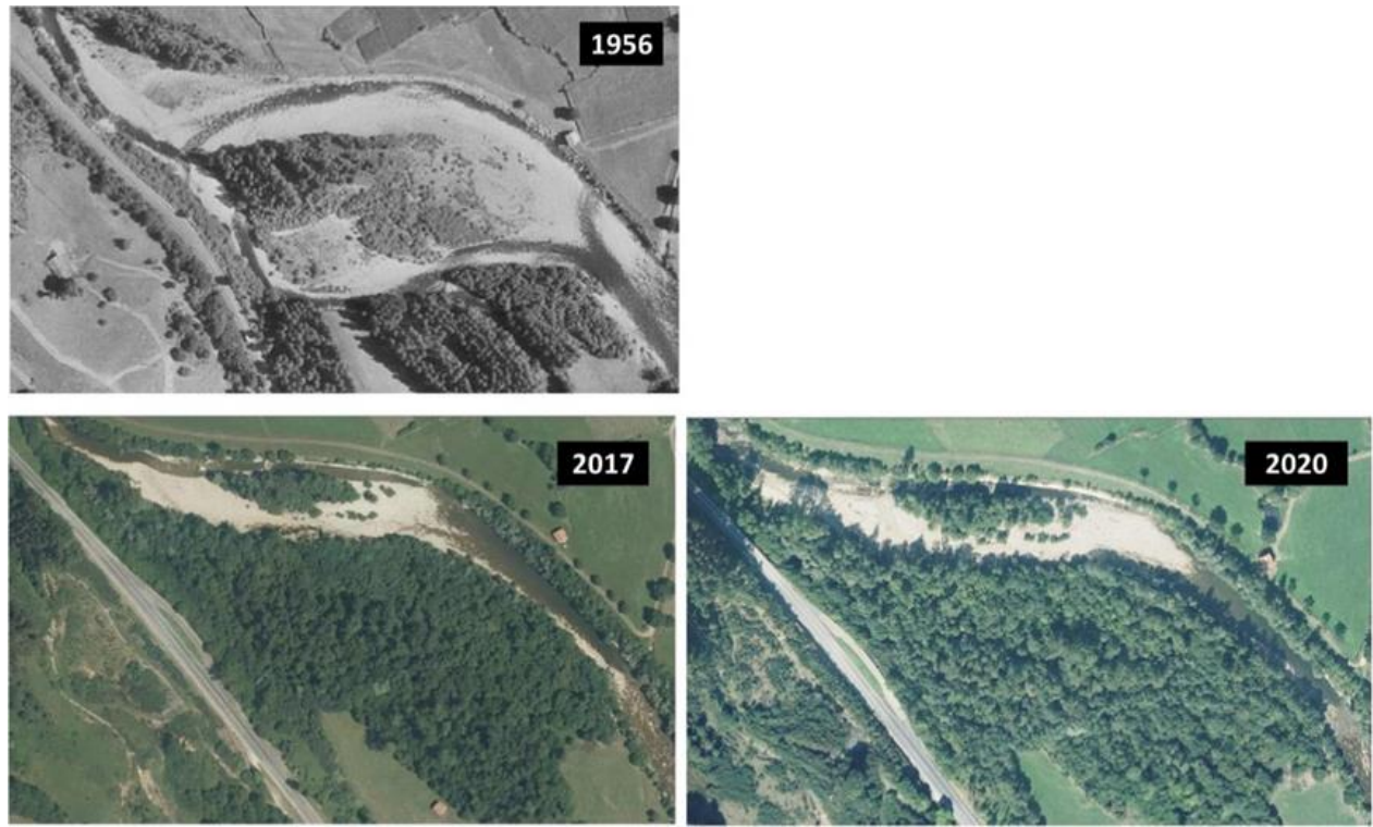
Figura 12. Vista de antiguas zonas de gravas desnudas en el interior del cauce activo del río Pas (tramo medio), colonizadas por la vegetación leñosa de ribera, al quedar hoy día fuera del canal fluvial por donde circulan las aguas.
