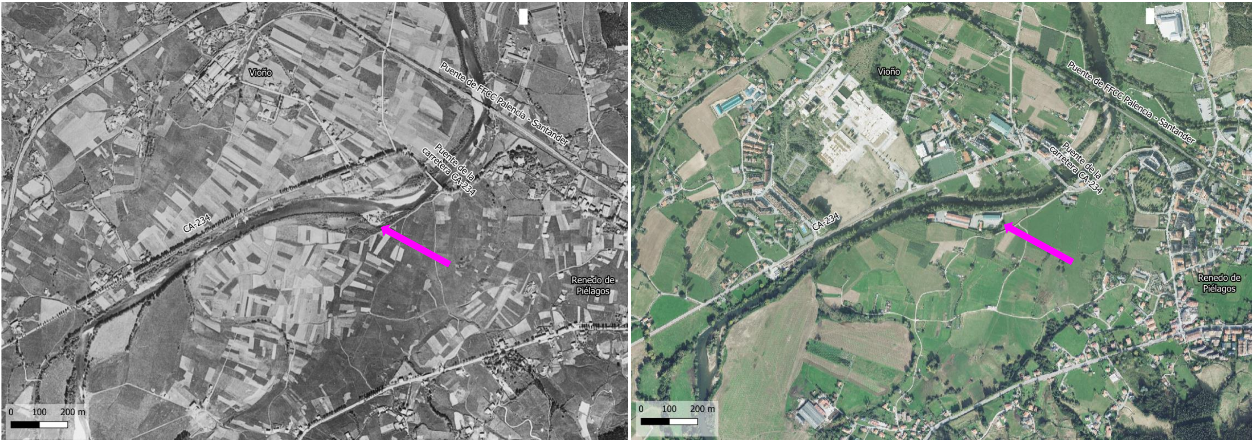
Figura 237. Análisis comparativo entre la situación histórica (1956) y la actual (2020) del río Pas en zona Vioño - Renedo. Se observa la ocupación antrópica de las márgenes, especialmente en la zona de Vioño, y el relleno antrópico y pérdida de ribera en la margen derecha aguas arriba del puente de la carretera CA-234.
