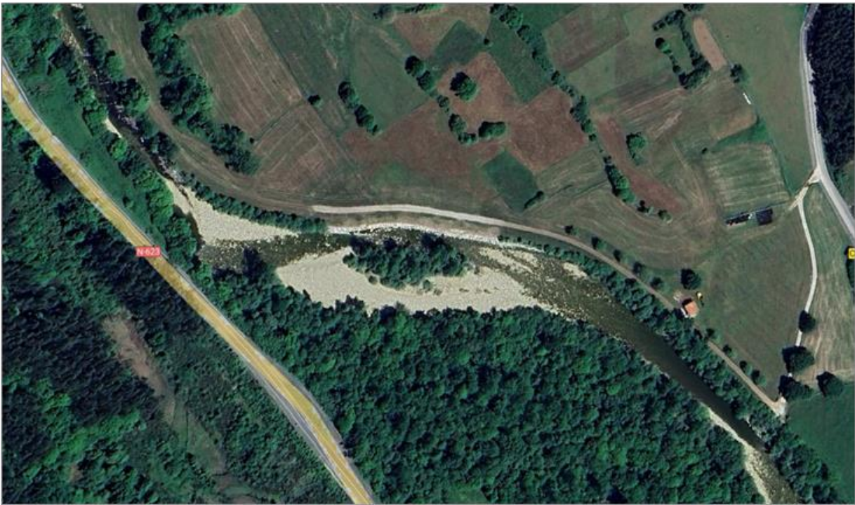
Figura 66. Zona de acumulación de sedimentos en el borde interior del meandro aguas abajo de Entrambasmestas. Aguas abajo, se observa incisión con afloramiento de roca madre.
