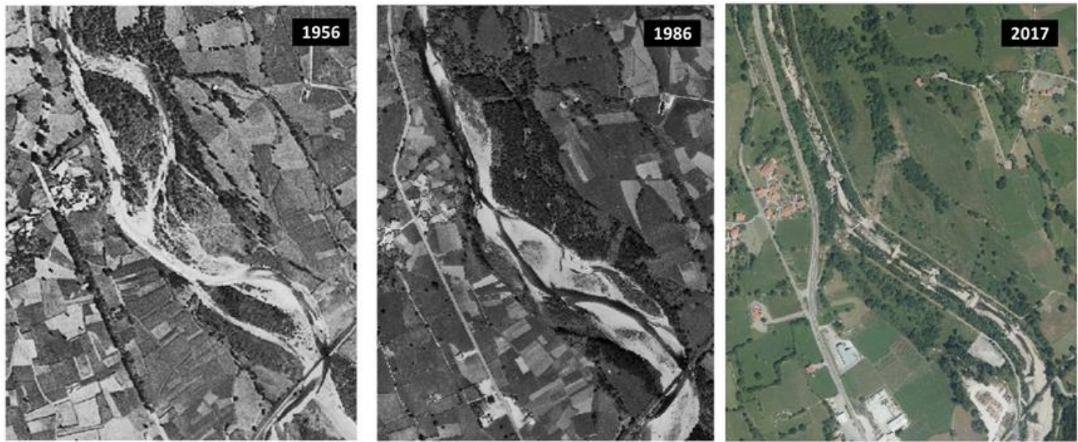
Figura 11. Vista de un sector del tramo trezado del río Pas antes y después de su canalización.
