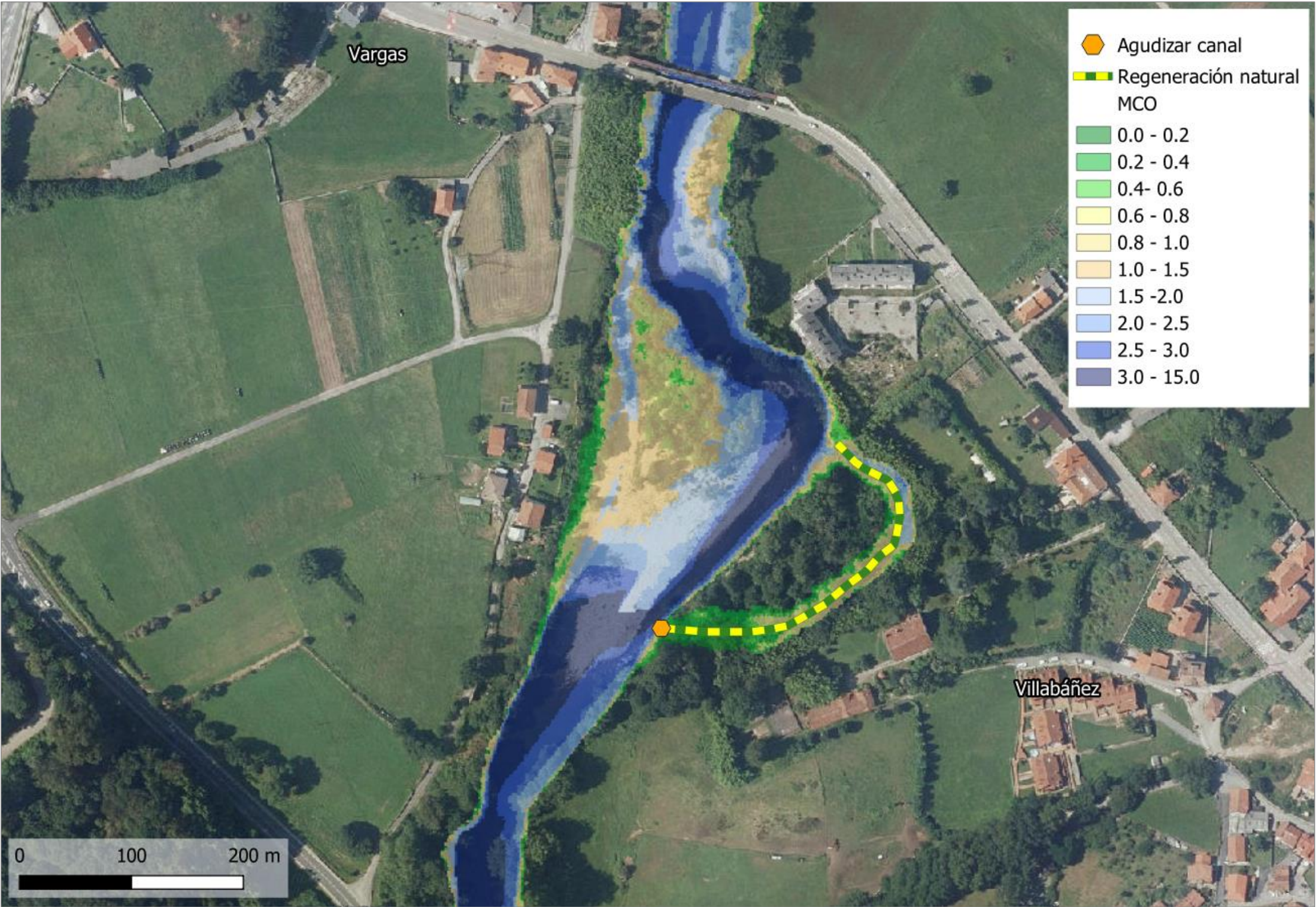
Figura 223. Actuación 7.1. Agudización y regeneración natural de canal para reactivación de brazo histórico en margen derecha del río Pas en Villabáñez (T.M. Castañeda) (Tramo 7).
