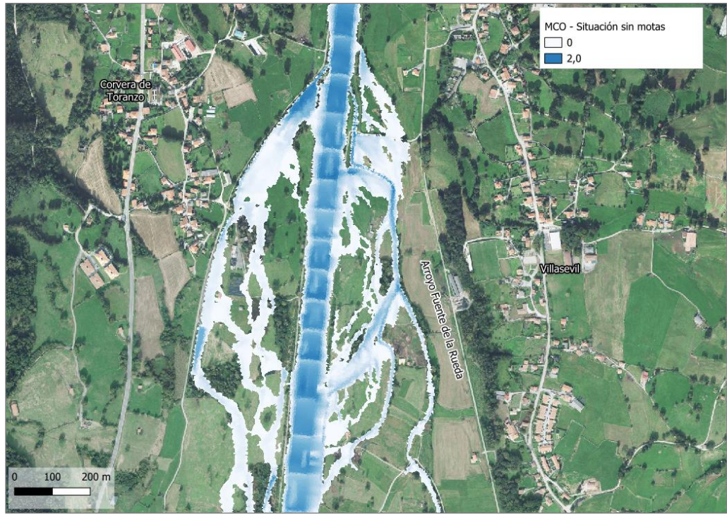
Figura 189. Máxima crecida ordinaria (MCO) en escenario "situación sin motas" en el río Pas en vega de Iruz, a la altura de Villasevil (T.M. Santiurde de Toranzo) (Tramo 5).
