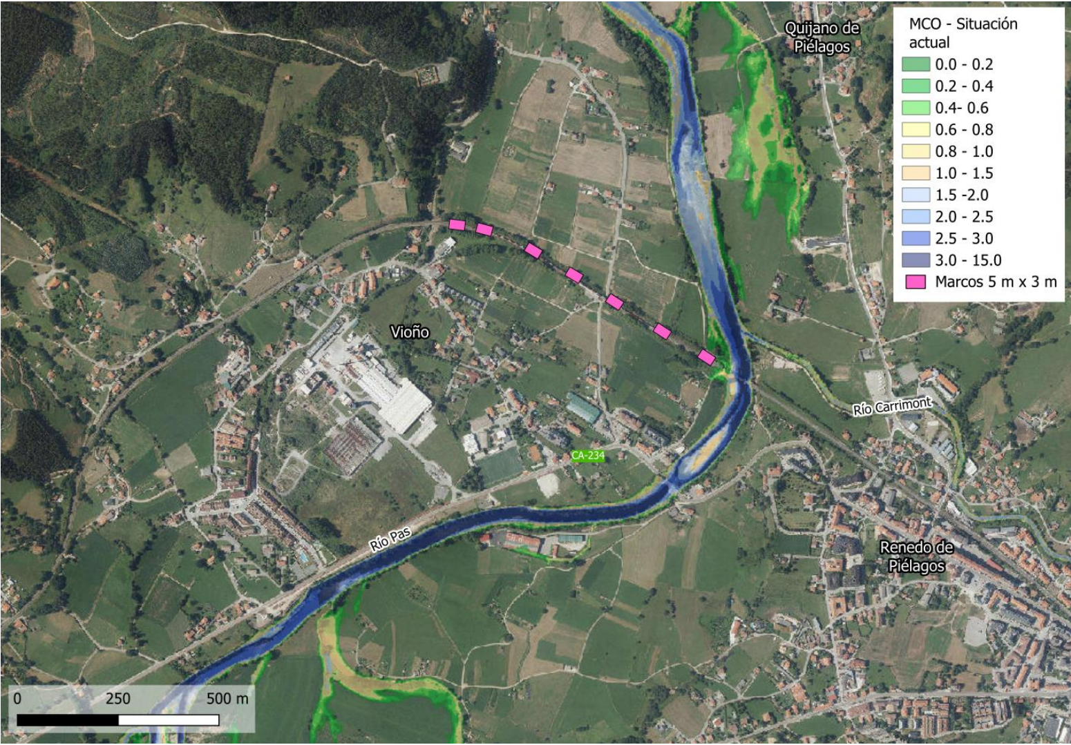
Figura 250. Actuación 8.2. Permeabilización ante avenidas mediante implantación de obras de drenaje transversal bajo la línea de FFCC Palencia-Santander en margen izquierda del río Pas en Vioño (T.M. Piélagos) (Tramo 8).
