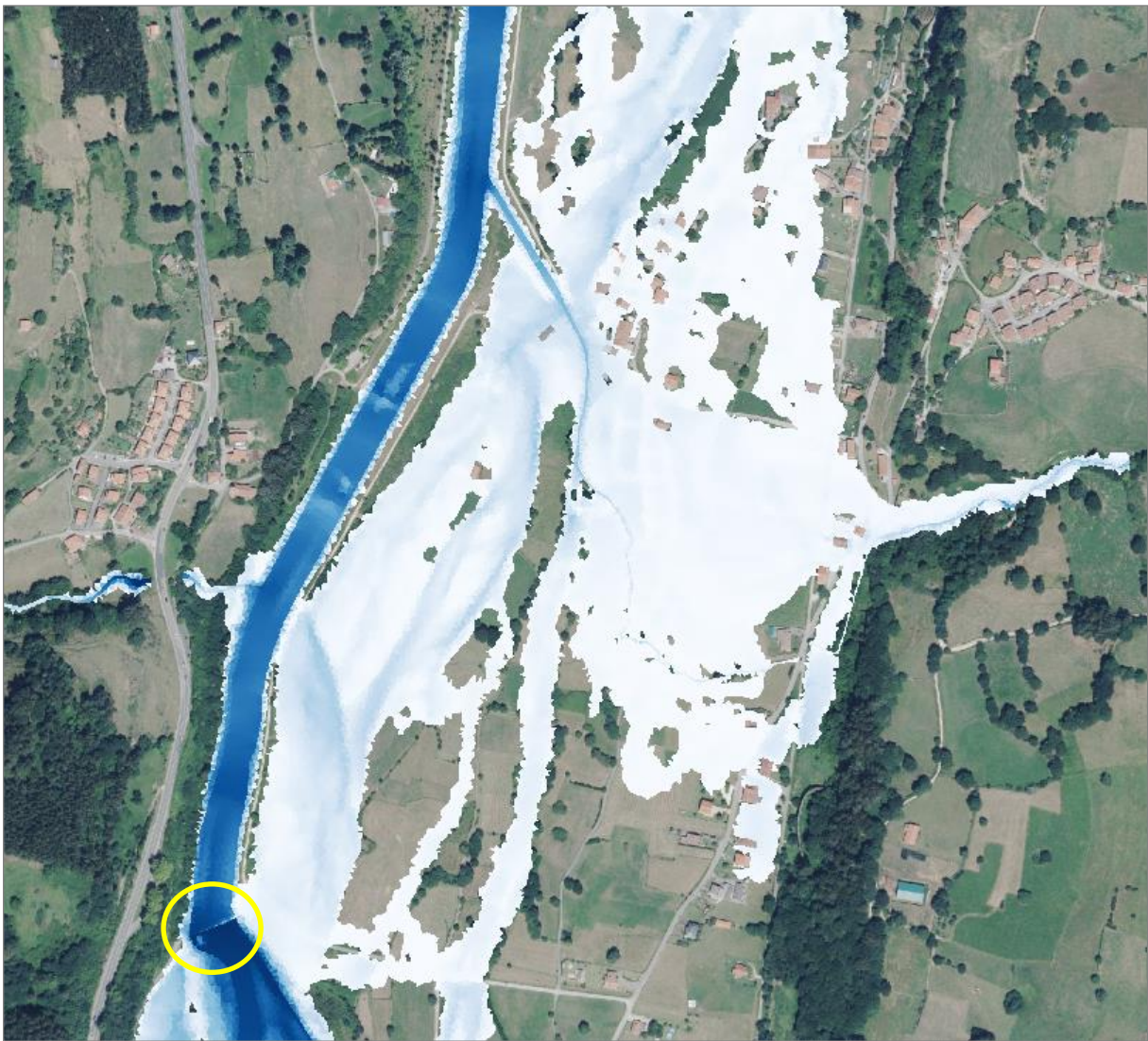
Figura 45. Tramo 4. Avenida T=500 años en situación actual puente de La Unión Deseada y Prases. Se observa que la afección se provoca por desbordamiento antes del Puente de la Unión Deseada en el tramo anterior.
