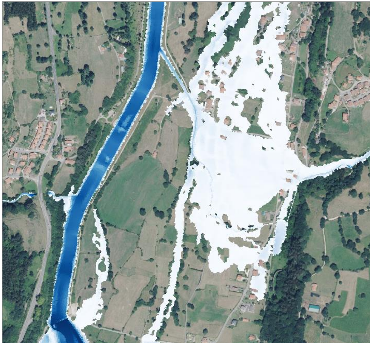
Figura 44. Tramo 4. Avenida T=100 años en situación actual entre el puente de La Unión Deseada y Prases. Se observa que la afección únicamente proviene de los cauces tributarios laterales.
