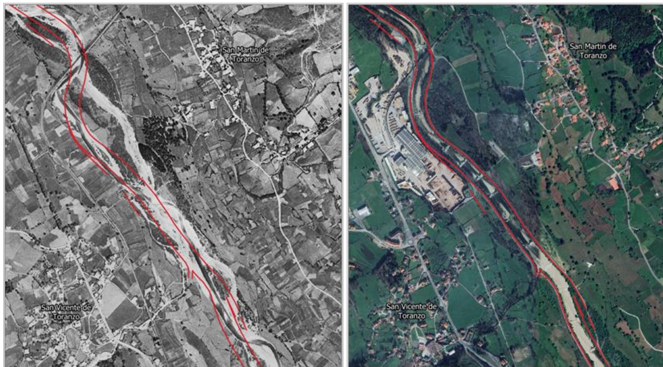
Figura 114. Análisis comparativo entre la situación histórica (1956) y la actual (2020) del río Pas en zona Vejorís-San Martín de Toranzo con obras longitudinales existentes en la actualidad. En la figura de la derecha, se observa la Invasión de densa vegetación de las zonas exteriores a la mota que antiguamente era cauce activo con acumulación de sedimentos.
