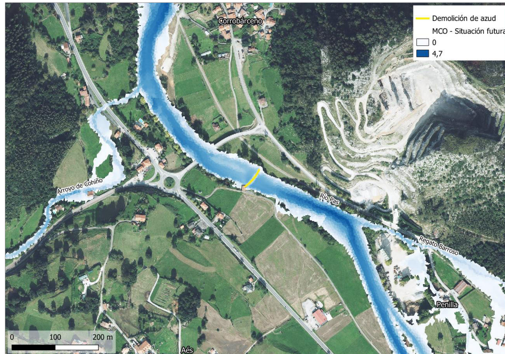
Figura 154. Actuación 6.2. Demolición del azud de Aés para recuperar el estado hidromorfológico del río Pas (T.M. Puente Viesgo) (Tramo 6).
