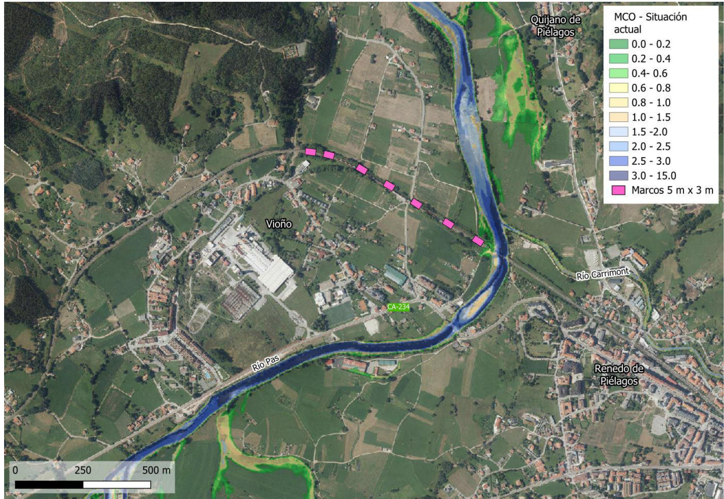
Figura 179. Actuación 8.2. Permeabilización ante avenidas mediante implantación de obras de drenaje transversal bajo la línea de FFCC Palencia-Santander en margen izquierda del río Pas en Vioño (T.M. Piélagos) (Tramo 8).
