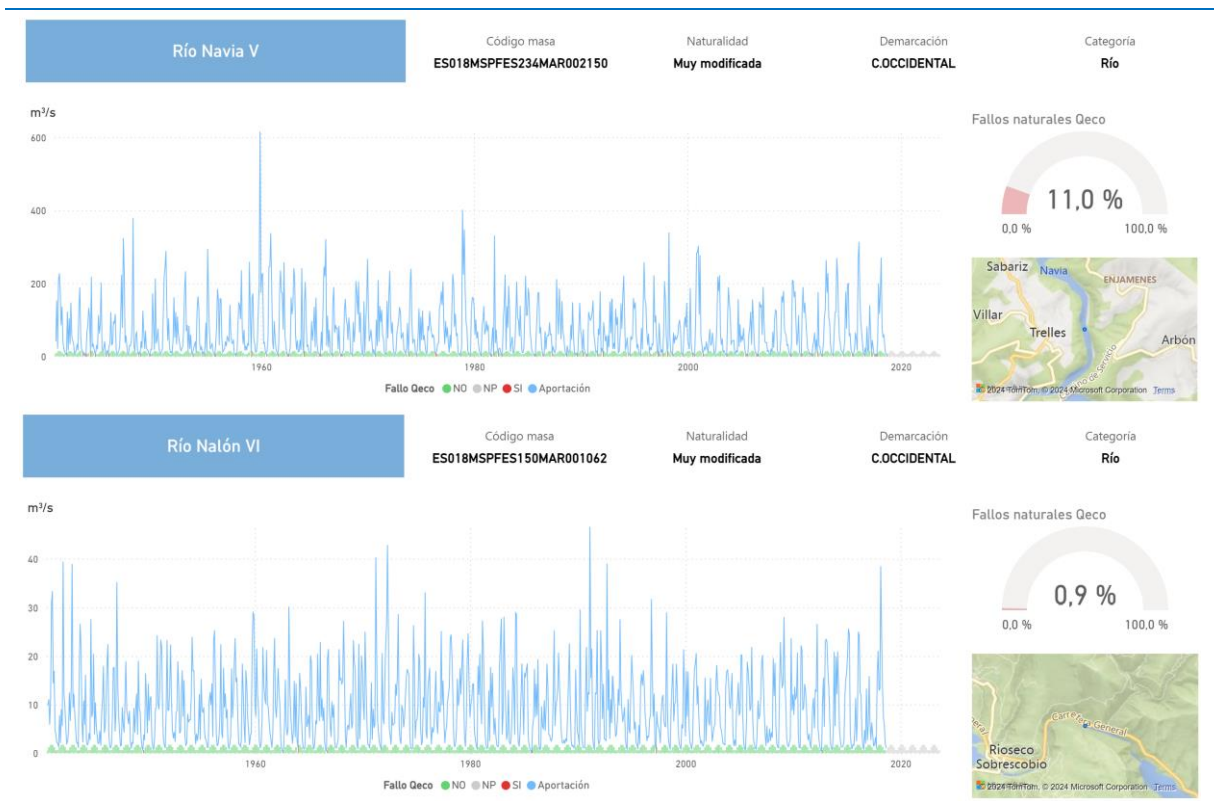
Figura 44. Ejemplos de comparación del régimen de caudales naturales con el régimen de mínimos
