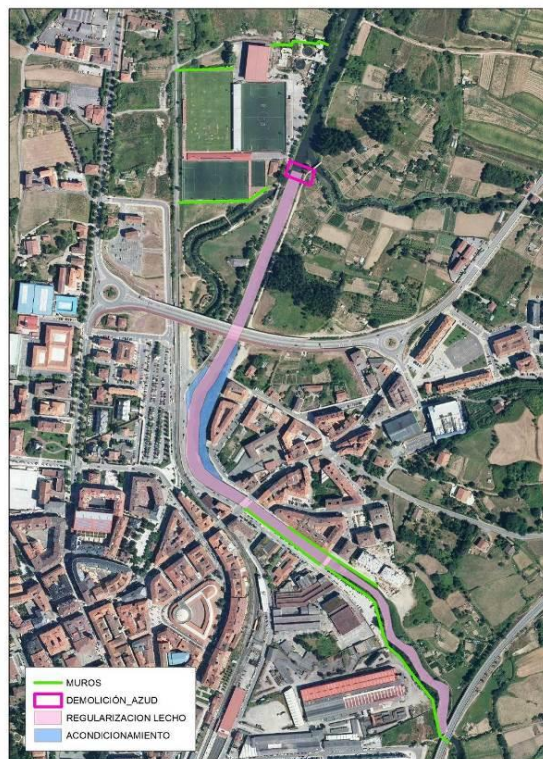
Figura 25. Actuaciones propuestas para la Fase 1. Opción C. ARPSI de Gernika. PGRI 1er ciclo
