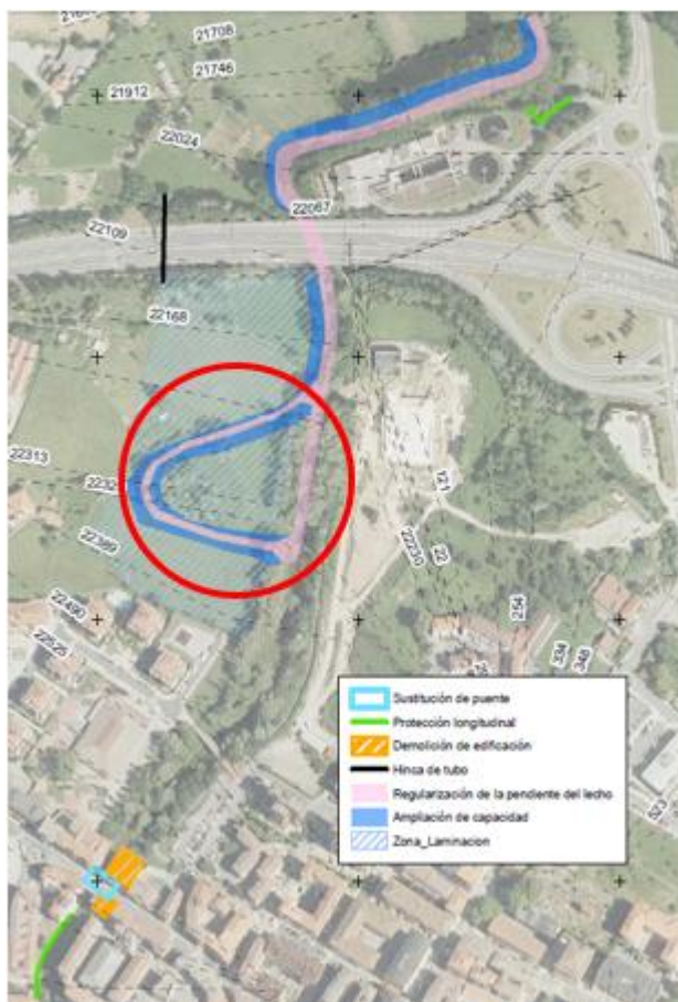
Figura 35. Ubicación en planta de actuaciones ARPSI de Mungia (en el círculo rojo las principales modificaciones). Fuente: Revisión y actualización del Plan de Gestión del Riesgo de Inundación. 2º CICLO. Anejo 3. Justificación de las medidas estructurales.
