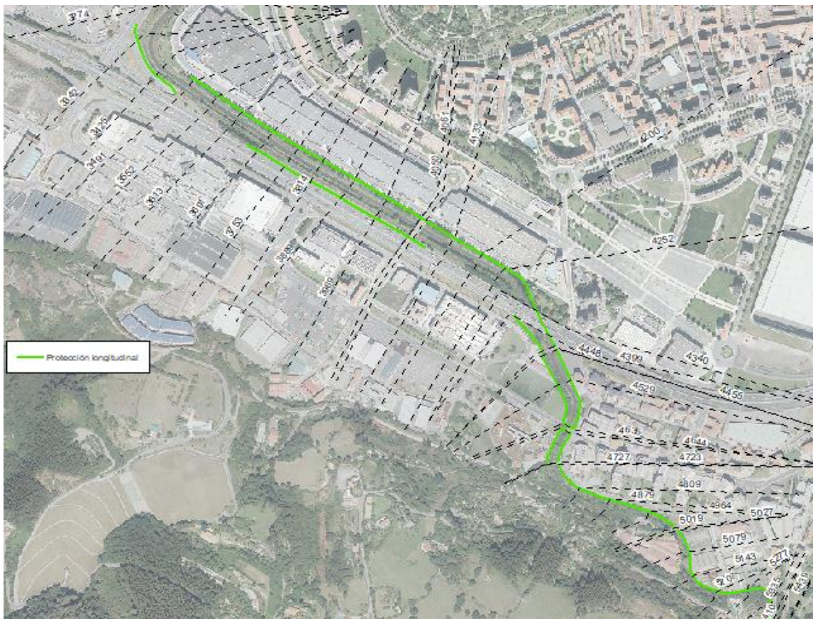
Figura 102. Actuaciones propuestas en la Fase 1. ARPSI de Galindo. Fuente: Revisión y actualización del Plan de Gestión del Riesgo de Inundación. 2º CICLO. Anejo 3. Justificación de las medidas estructurales.
