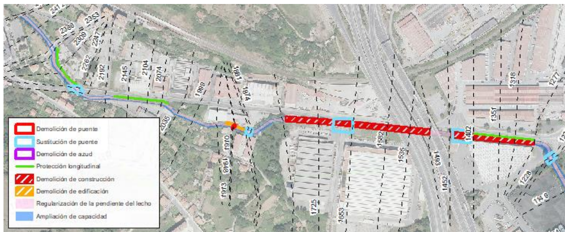
Figura 44. Actuaciones propuestas en la Fase 2. ARPSI de Galindo (continuación). Fuente: Revisión y actualización del Plan de Gestión del Riesgo de Inundación. 2º CICLO. Anejo 3. Justificación de las medidas estructurales.
