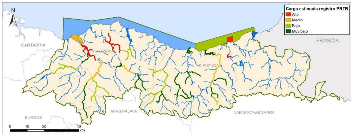
**Figura 20.** Nivel de presión de las masas de agua superficiales según la carga anual de contaminantes declarada en el registro PRTR.
