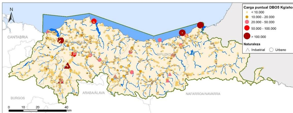
Figura 15. Vertidos clasificados según carga de vertido de DBO5 (Kg/año). Aguas superficiales
