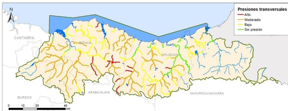
**Figura 64** Categorizado de las masas de agua de tipo río de acuerdo con el Índice de Compartimentación.
