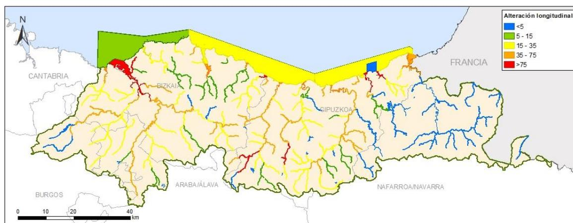
Figura 59. Porcentaje de longitud alterada por alteraciones físicas del cauce/ lecho/ ribera/ márgenes con respecto a la longitud/área de la masa de agua.
