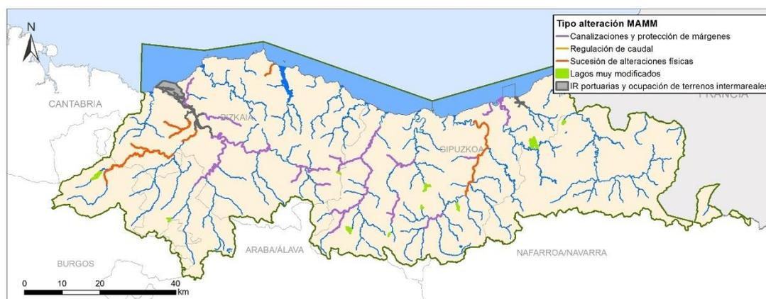
Figura 104. Masas de agua muy modificadas por tipología de alteración hidromorfológica.
