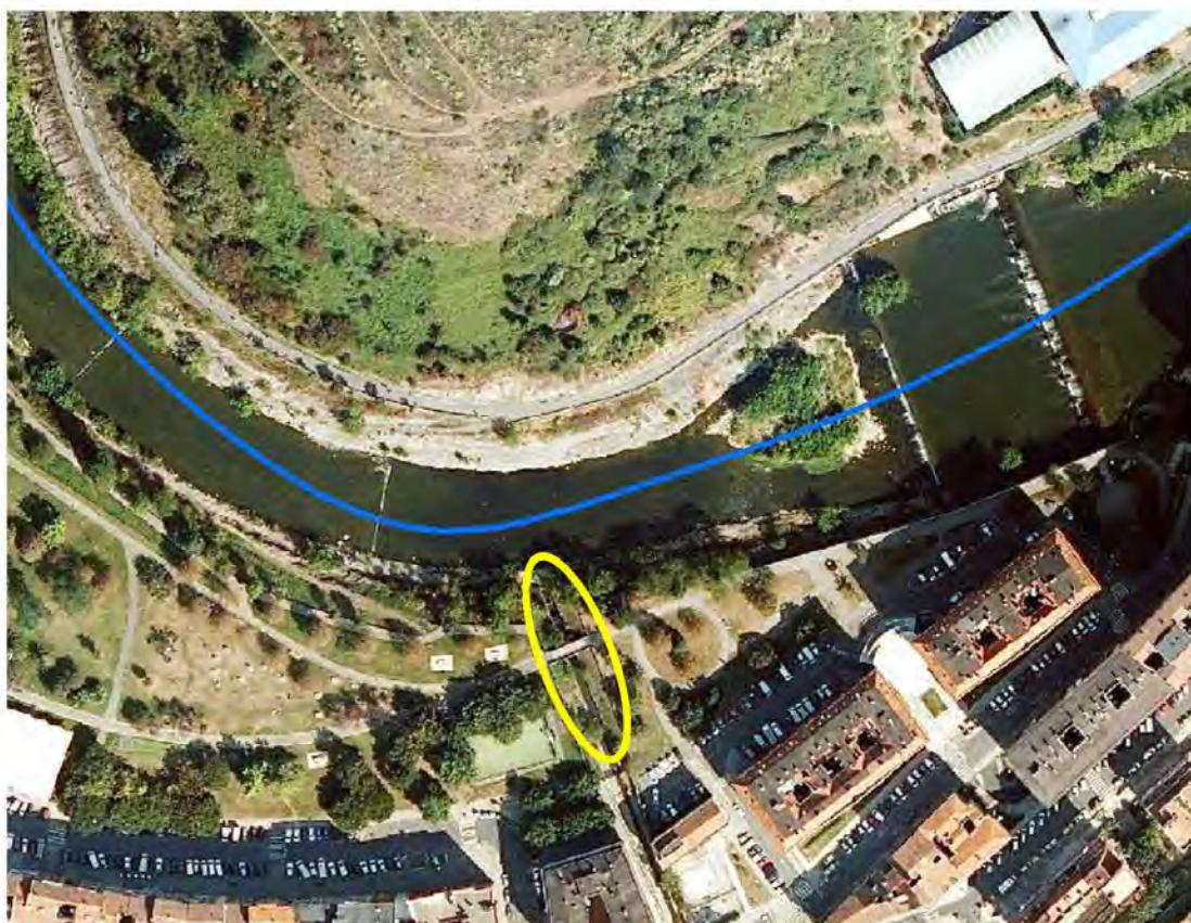
La propuesta consiste en la eliminación del hormigón de encauzamiento en los últimos 60 m. de este arroyo. Se eliminarán los paramentos laterales así como la solera. Seguidamente, se verterá tierra vegetal y se hará un trabajo de remodelación y suavizado de las formas. Finalmente se realizará una siembra de herbáceas y se plantarán algunas especies arbóreas.
