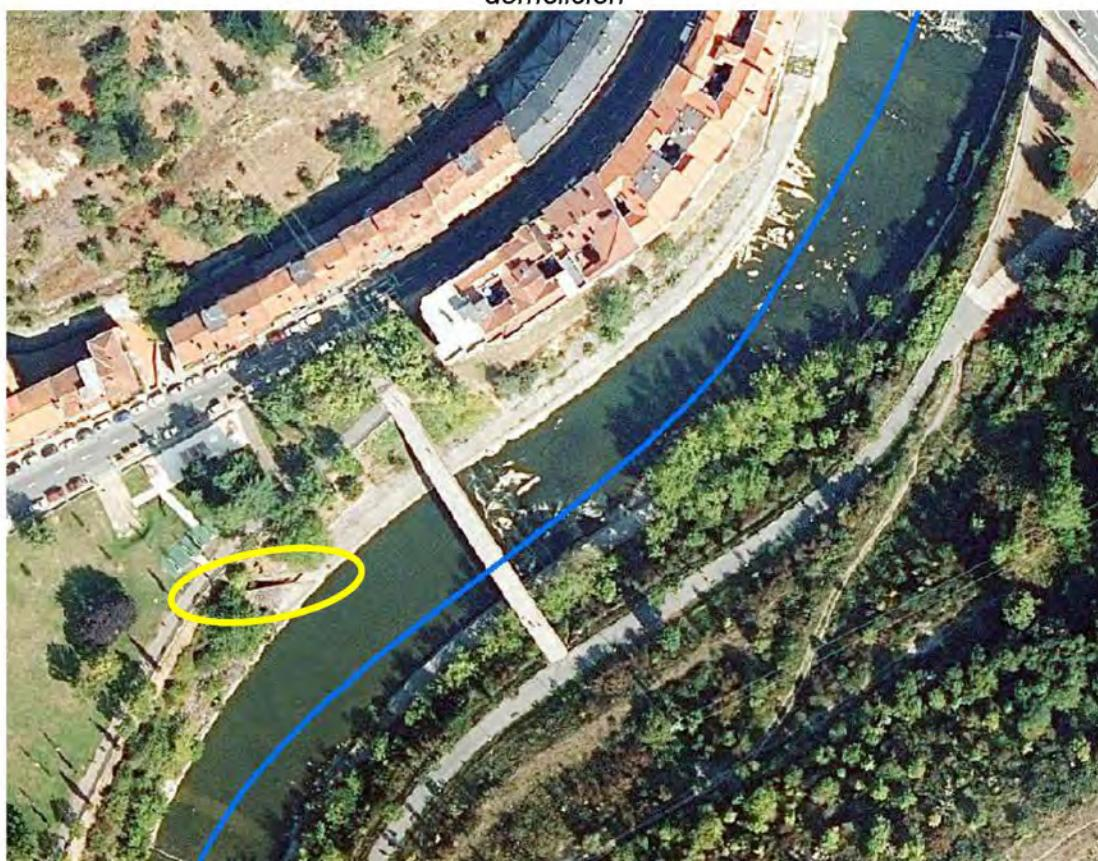
Además, se propone la demolición parcial de las estructuras que aparecen en ambas orillas a modo de deflector. Estas estructuras han sido recrecidas mediante ladrillos y bloques de hormigón recientes, adoptando una estética poco adecuada. Se propone demoler la parte superior de estas estructuras, dejando la parte original de piedras.
