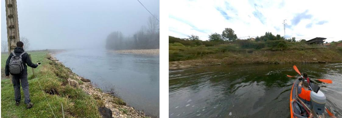
Figura 16. Trabajos de campo realizados para la identificación de orillas erosivas. A la izquierda mediante GPS y a la derecha en embarcación con cámara 360º.
