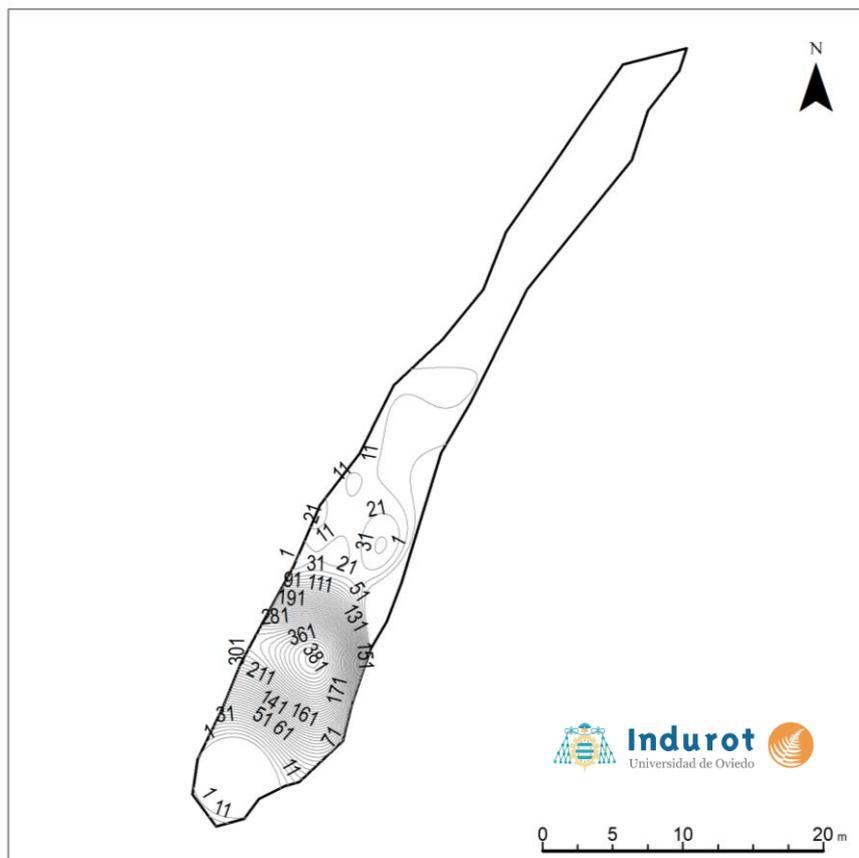
Figura 60. Distribución espacial de la susceptibilidad magnética ( $\times 10^{-7}$ ) en la Barra 1 del río Cubia tras la crecida de enero de 2023.
