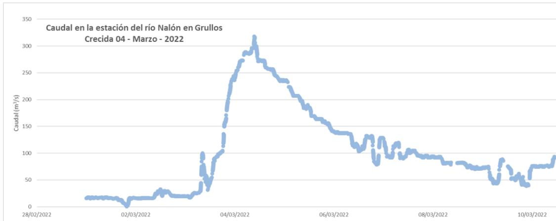
Figura 51. Caudales obtenidos según el registro de niveles de la estación de aforo 1368 en el río Nalón y su curva de gasto entre el 01/03/2022 y el 10/03/2022.
