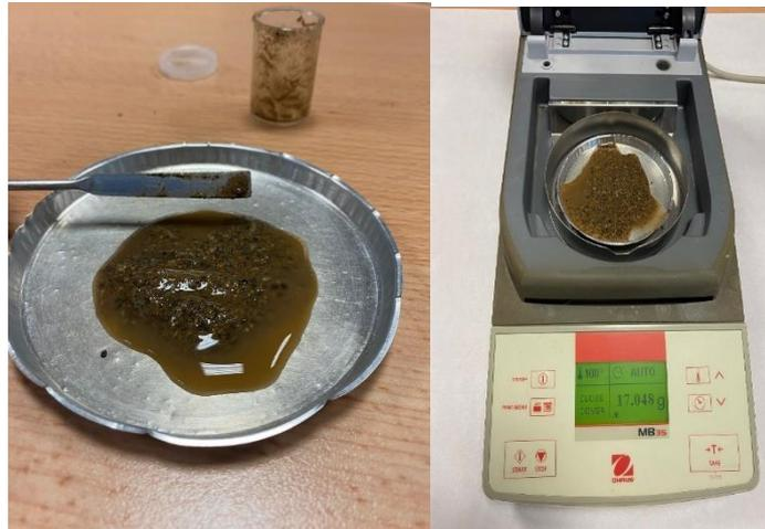
Figura 55. Determinación del grado de humedad de las muestras mediante termobalanza.
