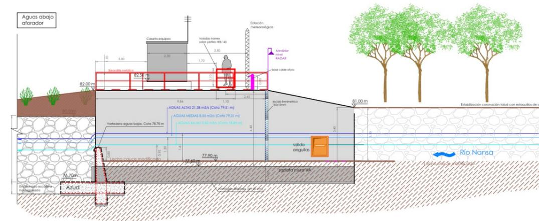
Obras de ejecución de nueva Estación de aforo, para incorporación al Sistema Automático de Información Hidrológica (SAI CHC):
