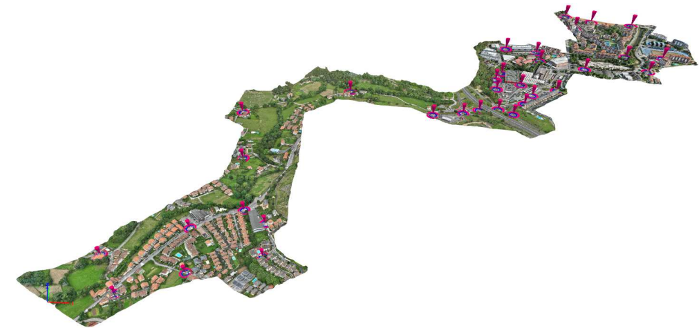
Figura 5: 33 Puntos de Apoyo/Control topográficos en tierra
