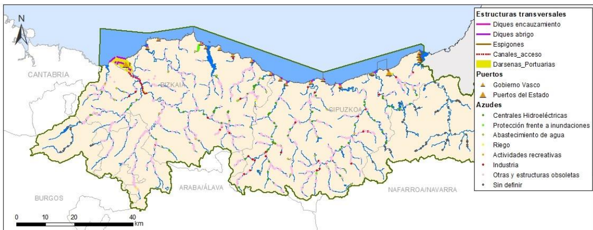
Figura 42. Localización de las alteraciones de la conectividad transversal
