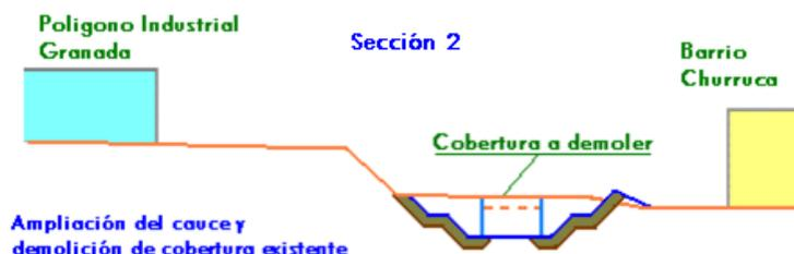
Figura 92 Sección tipo Fase 3. Anteproyecto de Actuaciones Hidráulicas en el río Granada.
