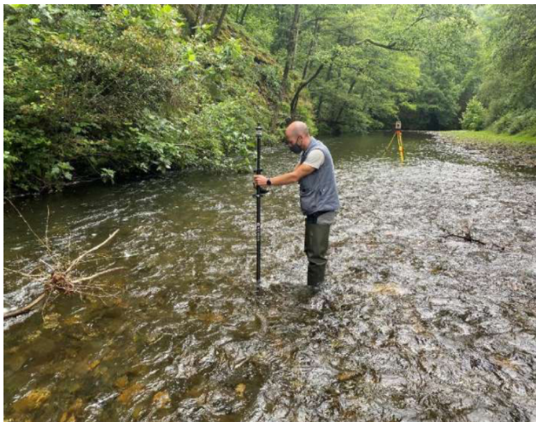
Figura 32. Trabajos de topografía en la zona central del tramo en aguas con rápidos.
