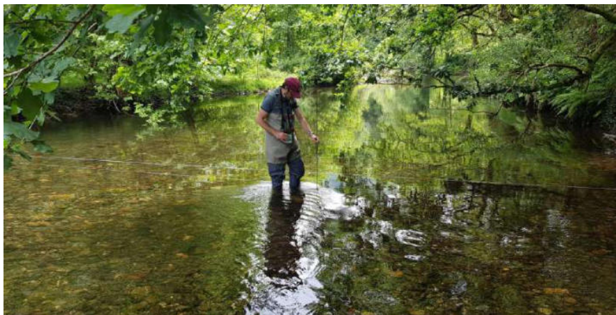
Figura 3. Ejemplo de aforo de sección fluvial con molinete.
