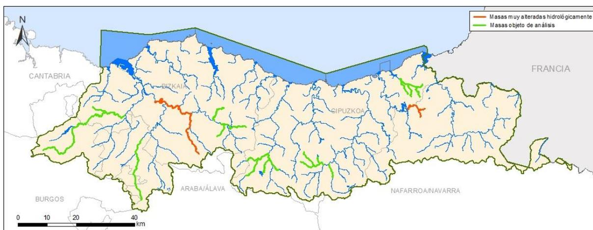
Figura 9. Masas de agua con análisis de alteración hidrológica.
