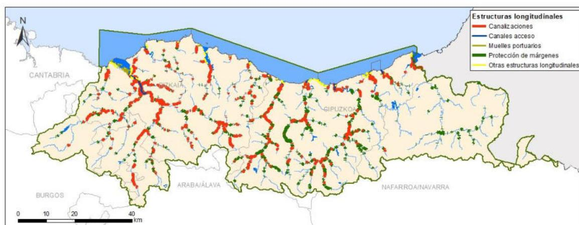
Figura 93. Estructuras longitudinales.
