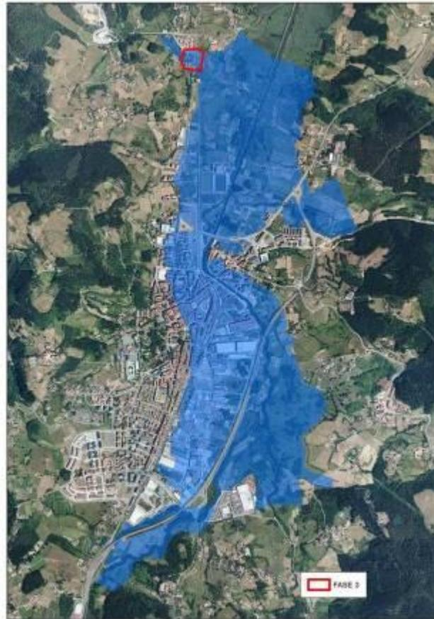
La inundabilidad se ve fuertemente condicionada por el obstáculo al flujo del puente de la BI-2235 y del FFCC existente aguas abajo. Sin la actuación sobre estas estructuras, y de forma particular del puente de la BI-2235, no es posible la reducción de la inundabilidad dentro de la fase 3. Estas actuaciones, como se recoge en el PGRI de primer ciclo, no resultan rentables económicamente y no suponen una mejora sensible en el sistema fluvial.
