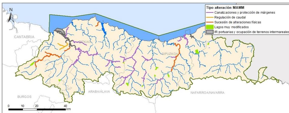
Figura 73. Masas de agua muy modificadas por tipología de alteración hidromorfológica.
