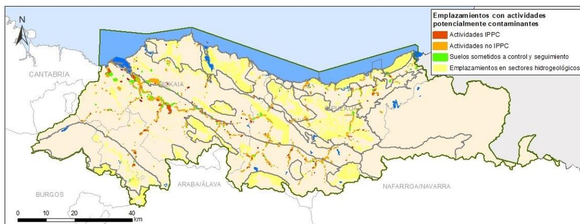
**Figura 60.** Distribución de los suelos potencialmente contaminados y suelos sometidos a control y seguimiento (CYS) sobre masas de agua subterránea.
