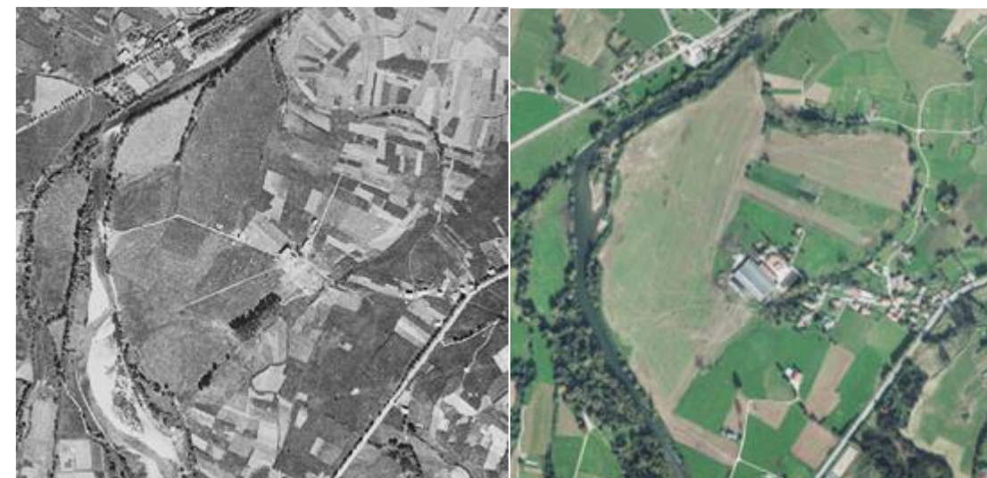
Fotografía 33. Detalle de movilidad lateral y antiguo meandro del Pas en 1956 (imagen derecha) y completamente estabilizado por escolleras y vegetación riparia con intensificación del uso agrícola y periurbano de su margen derecha en la actualidad, 2020 (imagen derecha).
