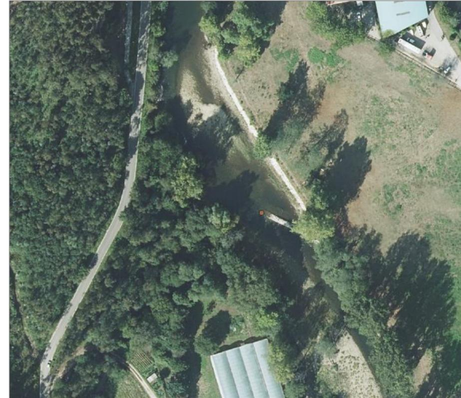
Fotografía 140. Azud en ruinas en el punto de reincorporación del canal de la central de Salcedo (Vioño) al Pas.
