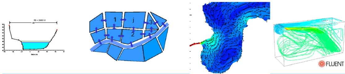
En el caso de modelos 1D, se parte de la hipótesis de líneas de flujo perpendiculares a las secciones y de un nivel constante en la sección.
