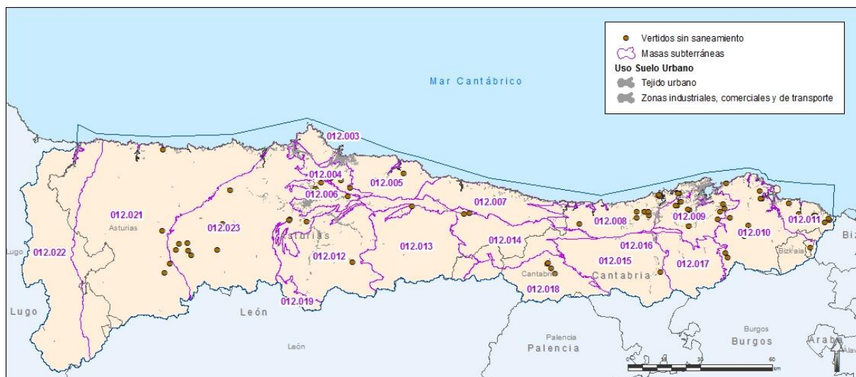
Figura 56. Distribución de los vertidos sin saneamiento que afectan a las masas subterráneas y la superficie de usos del suelo de tipo urbano
