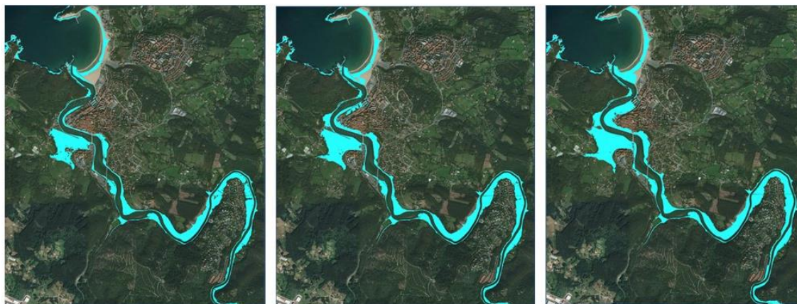
Figura 27. Inundación del estuario del río Butroe correspondiente a un evento extremo de 500 años de periodo de retorno para los siguientes escenarios: clima presente (izquierda) escenario climático RCP4.5 para el horizonte 2100, con un ascenso del nivel medio del mar de 0,51 m (centro) y escenario climático RCP8.5 para el horizonte 2100, con un ascenso del nivel medio del mar de 1,00 m (derecha).
