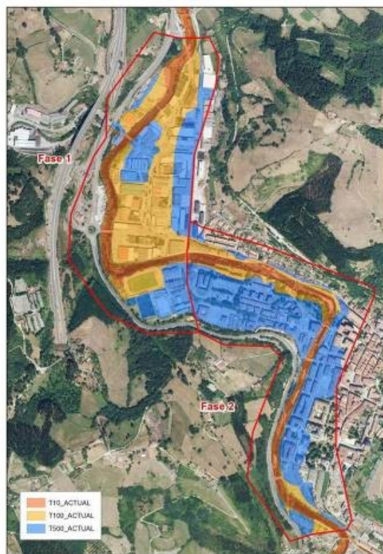
Figura 95 Zonas inundables actuales y delimitación de fases en el ARPSI de Bergara.
