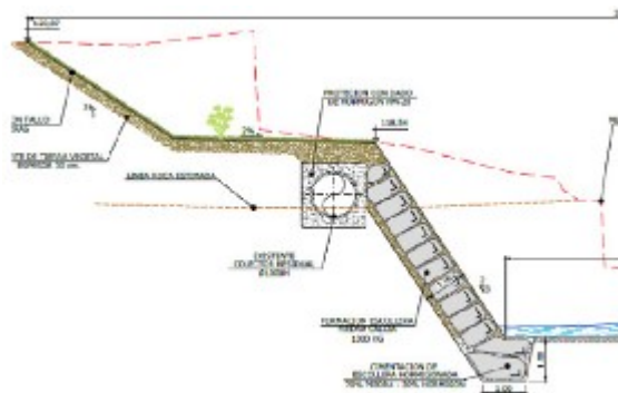
Figura 55 Sección tipo doble cauce.
