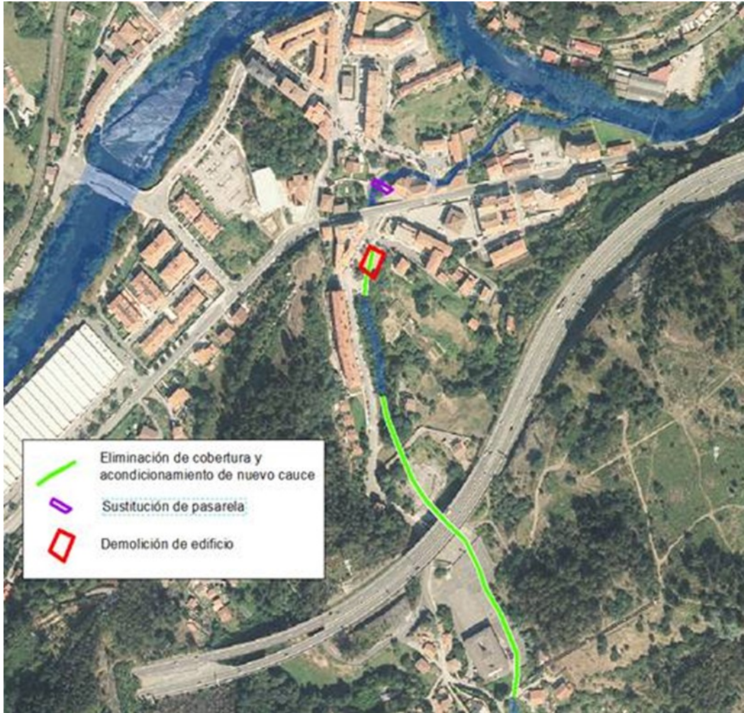
Figura 113 Ubicación en planta de actuaciones ARPSI Alonsotegi-2
