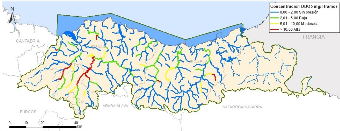
Figura 11. Relación entre la carga de materia orgánica acumulada y el caudal ecológico mínimo en aguas bajas (mg DBO5/l) por tramo de masa de agua tipo río.
