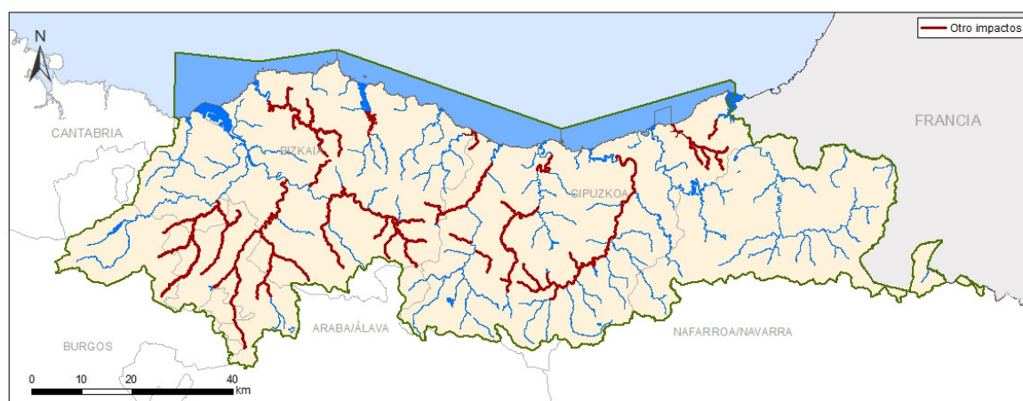
Figura 11. Masas de agua en riesgo de no alcanzar los objetivos ambientales en 2021 por índices bióticos (OTHE), cuyo origen está relacionado con el vertido y/o desbordamientos de la red de saneamiento de aguas residuales urbanas.
