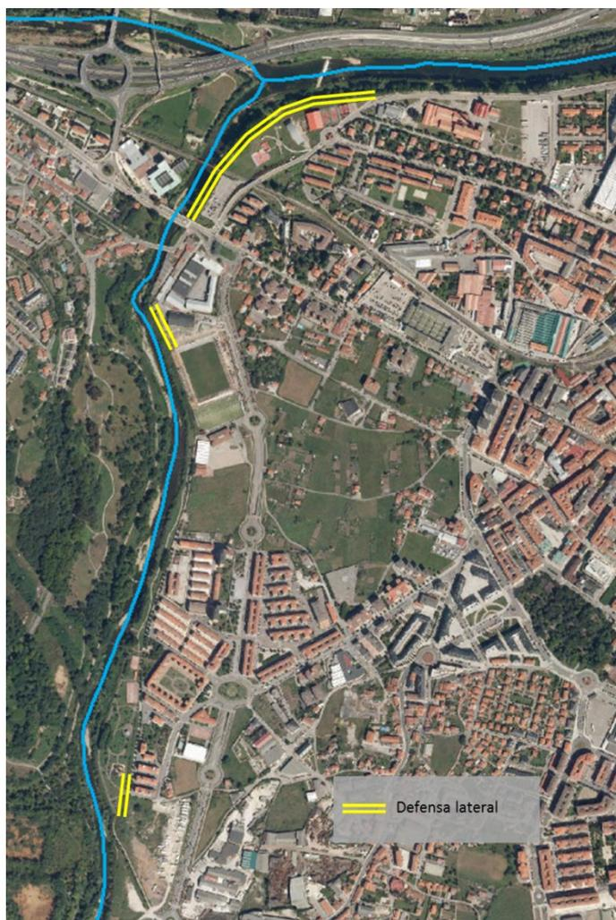
Figura 70.- Defensas laterales de protección del núcleo urbano de Torrelavega
