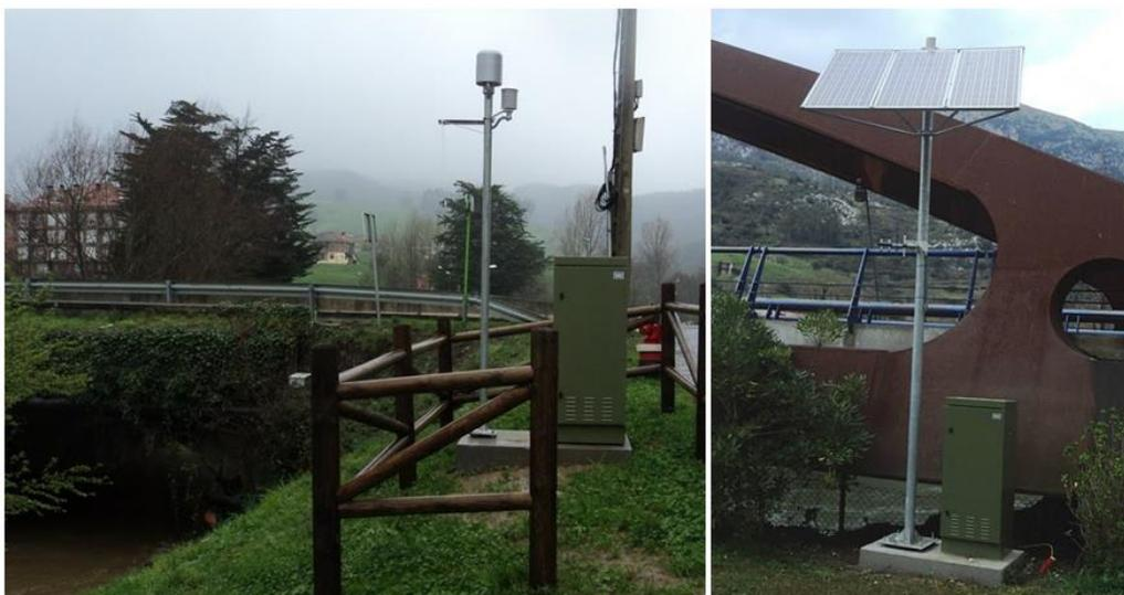
Figura 34.- Estaciones automáticas de bajo coste de la red SAI. Conectada a la red eléctrica (izquierda) y con panel solar (derecha)
