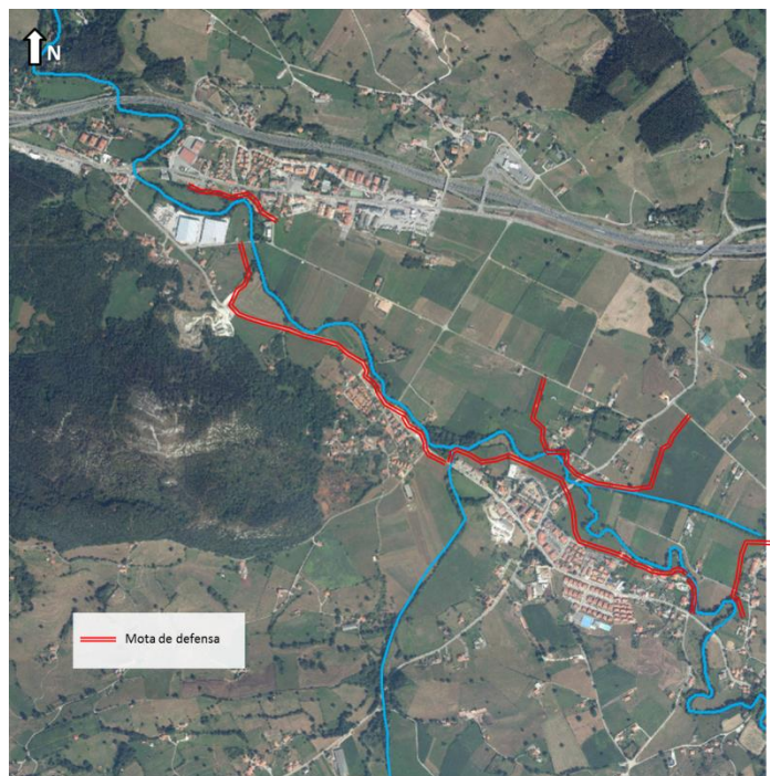
Figura 18.- Trazado aproximado de motas defensivas en el río Aguanaz
