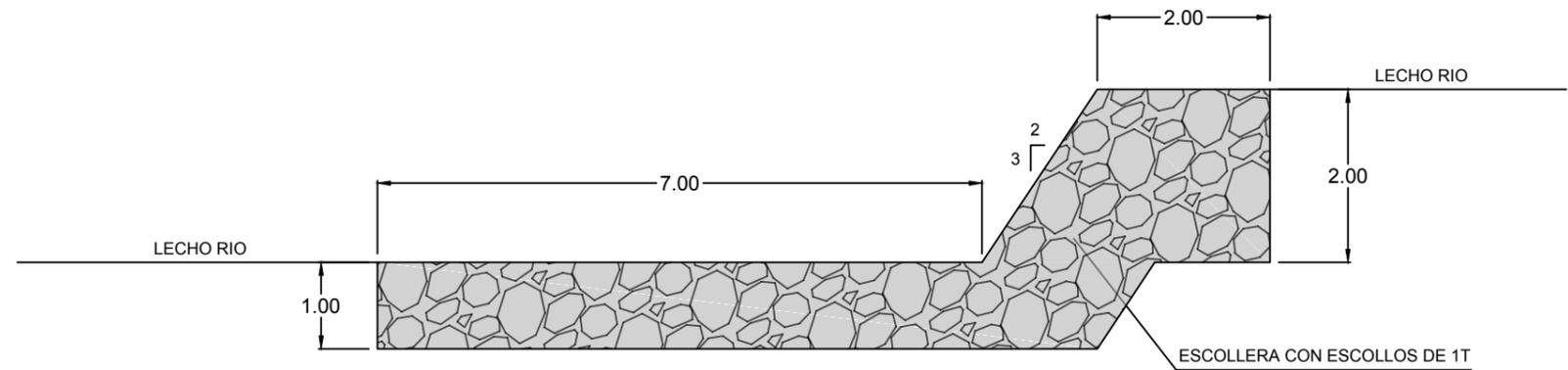
SECCION REFUERZO Y PROTECCION POZO
