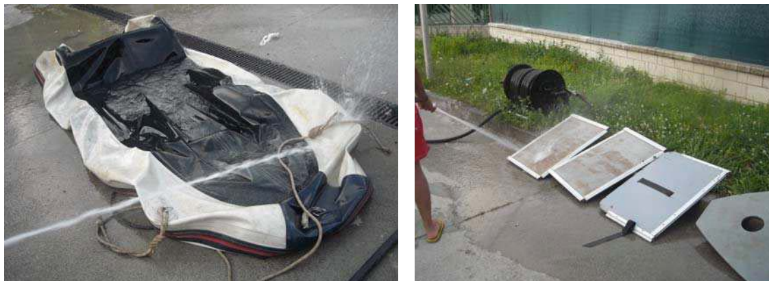
Izquierda: lavado a presión del exterior de la barca una vez desinflada y desmontada. Derecha: lavado a presión de las tablas que forman la estructura de la barca.
