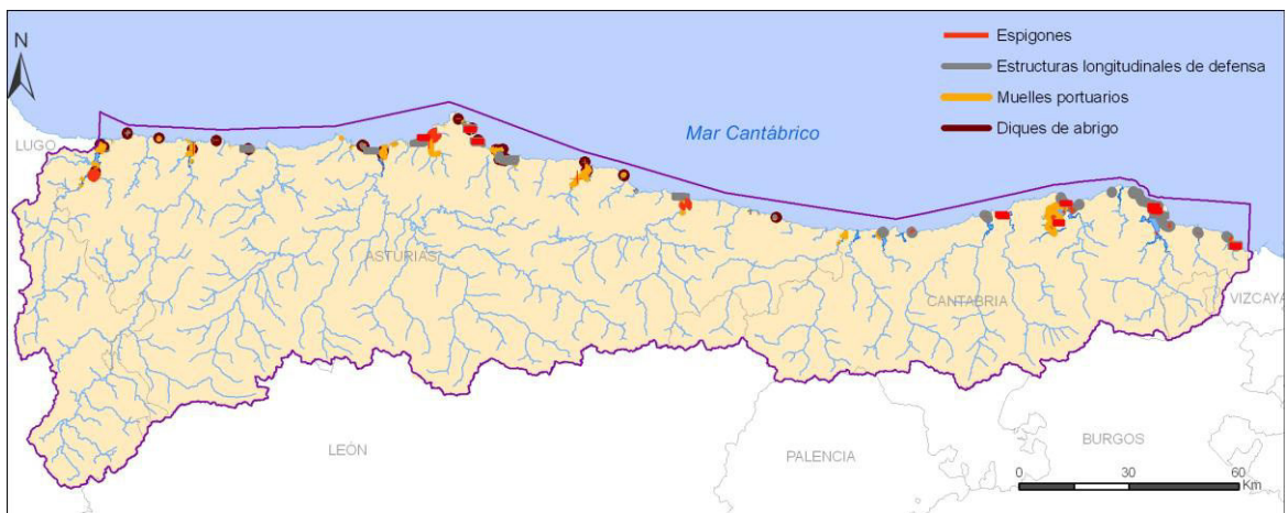
Figura 20. Presiones alteraciones morfológicas en aguas de transición y costeras causadas por muelles portuarios, espigones, diques de abrigo y estructuras longitudinales de defensa
