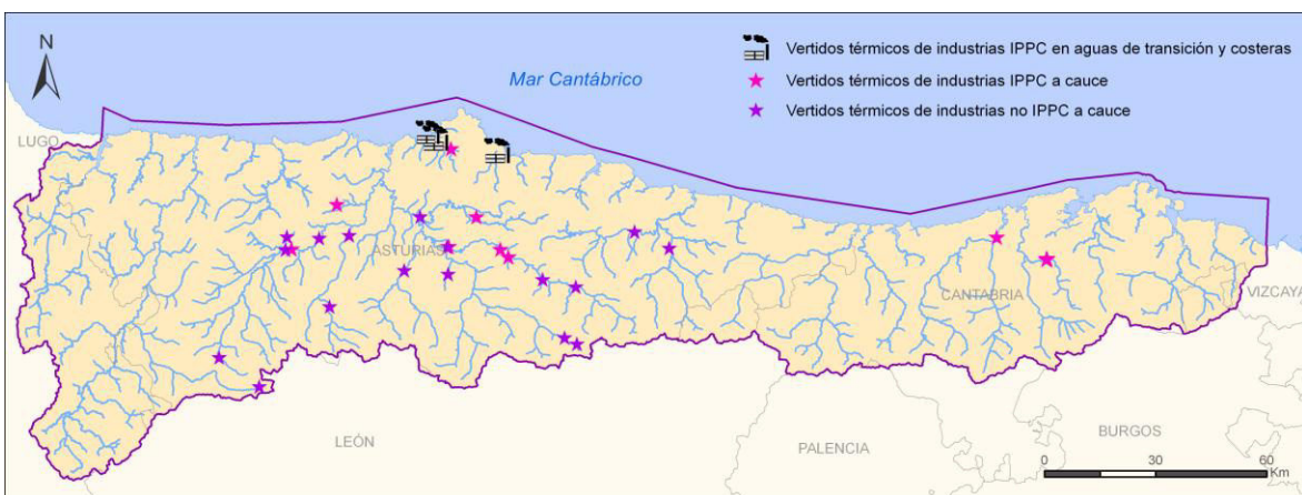
Figura 15. Vertidos térmicos procedentes de las aguas de refrigeración con un volumen superior a 100.000 m 3 /año, procedentes de centrales de generación de electricidad y de otro tipo de industrias y clasificadas como industrias IPPC o no IPPC
