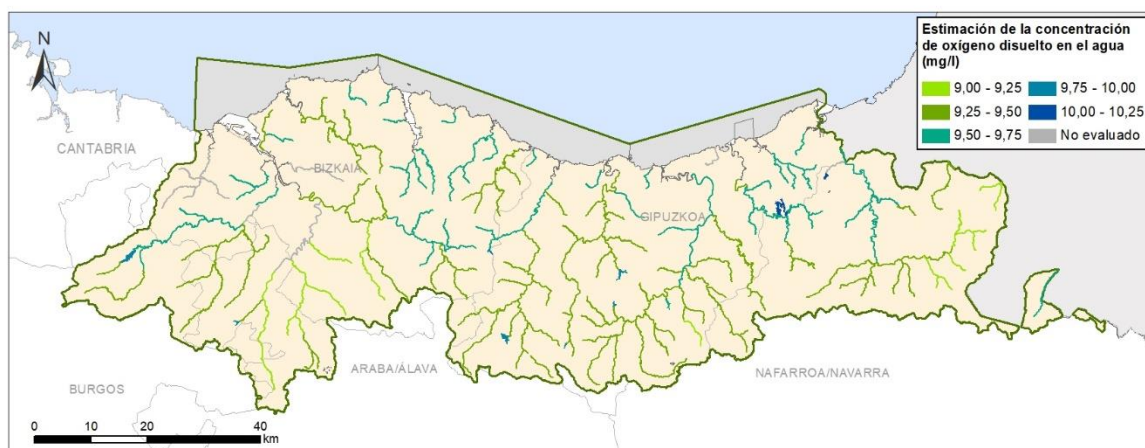
Figura 19. Estimación de la concentración de oxígeno disuelto en el agua (mgO 2 /l) calculada en función de la temperatura y la altitud en el mes de agosto.
