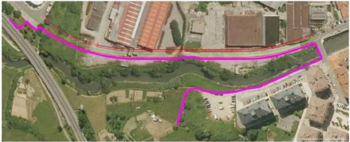
Figura 72 Muros propuestos de 1 m de altura.
