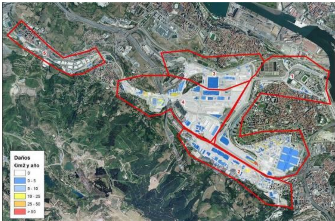
Figura 89 Ámbitos de actuación y daños en el ARPSI de Galindo.
