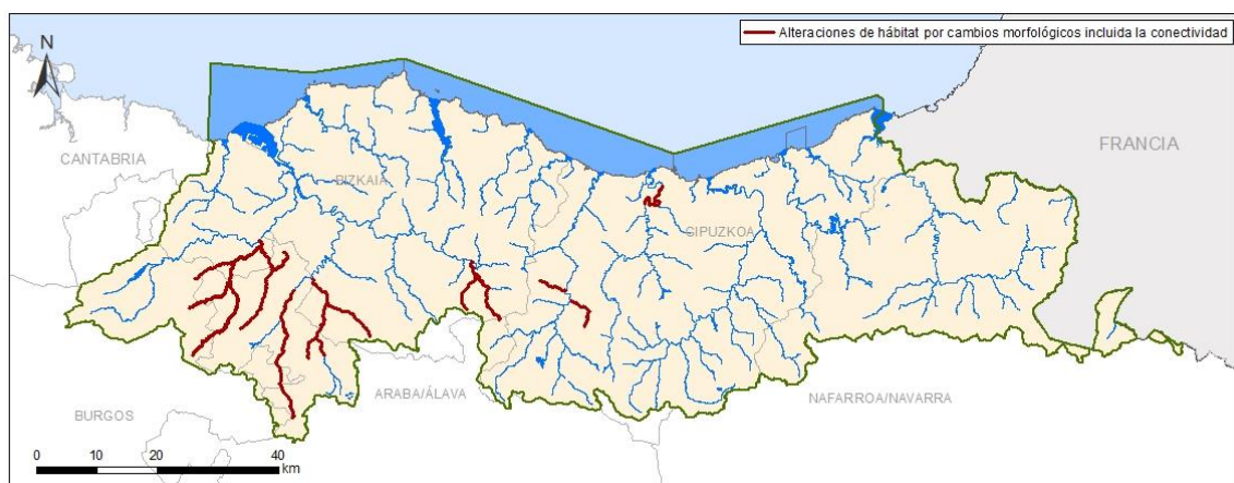
Figura 74. Masas de agua superficiales con impacto por cambios morfológicos incluida la conectividad (HMOC).
