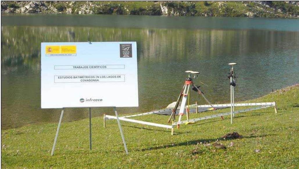
Estación base, GPS cinemático preparado, Stop & Go referenciándose y GPS Trimble tomando la posición real de la estación base.
