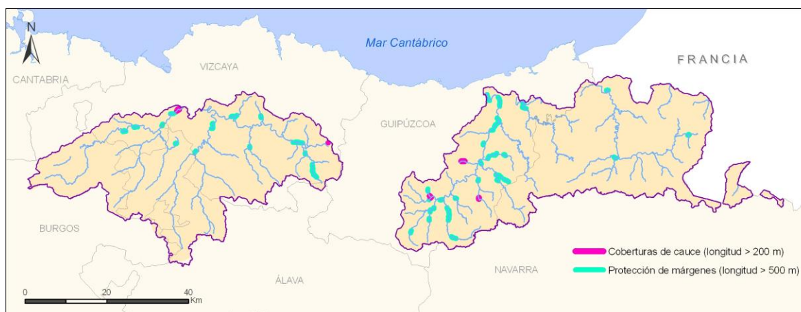
Figura 32. Presiones por alteraciones morfológicas en masas de agua río causadas por las coberturas de cauces y la protecciones de márgenes
