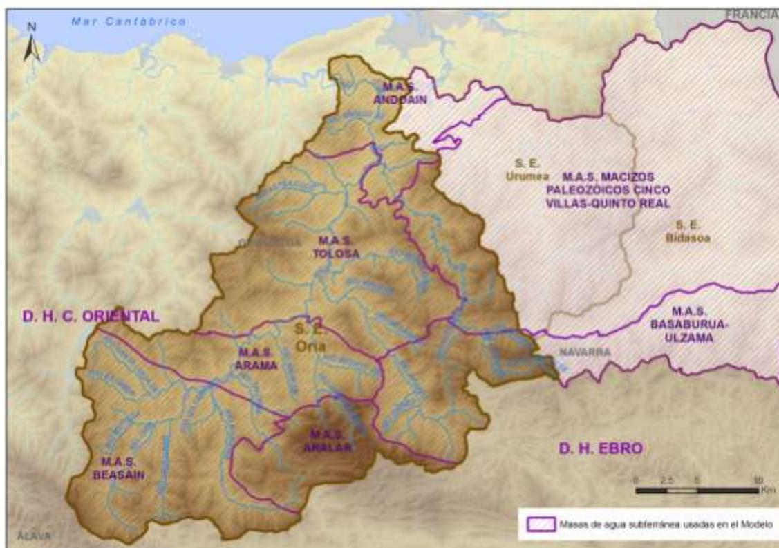
Figura 25. Acuíferos incluidos en el modelo de simulación del sistema Oriá
