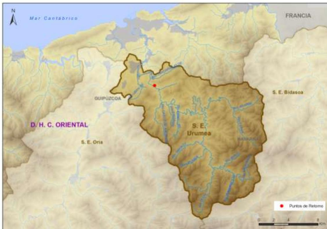
Figura 47. Localización de los puntos de retornos de demandas considerados en el modelo de simulación del sistema Urumea
