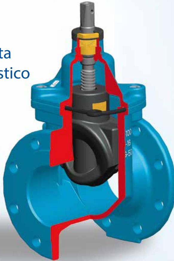
Cuerpo y tapa en fundición nodular EN-GJS-500-7 (GGG-50), recubrimiento interior y exterior epoxi aplicado electrostáticamente. Color azul Ral 5015, como estándar.
