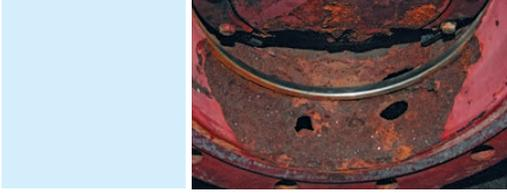
*El uso incorrecto continuo de válvulas de mariposa como válvula de control, da como resultado un daño severo del material, como se observa en esta válvula desmontada después de un año trabajando con agua de mar.*
