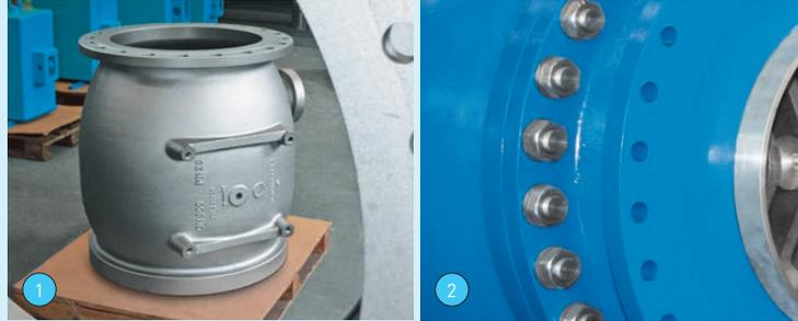
El revestimiento epoxi aplicado utilizando un proceso de recubrimiento en polvo es uno de los métodos más frecuentemente utilizados de protección contra la corrosión. Las piezas fundidas primero se granallan con un granulado especial para que sean metálicamente brillantes [1]. El revestimiento se aplica electrostáticamente con un espesor definido con precisión y le sigue el proceso de fusión exactamente a una temperatura de 210 ° C.
