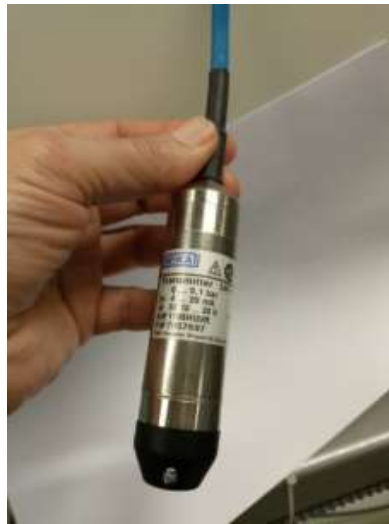
Foto de un instrumento de medida de nivel presostático con la conexión eléctrica sellada, similar al que se empleará.
