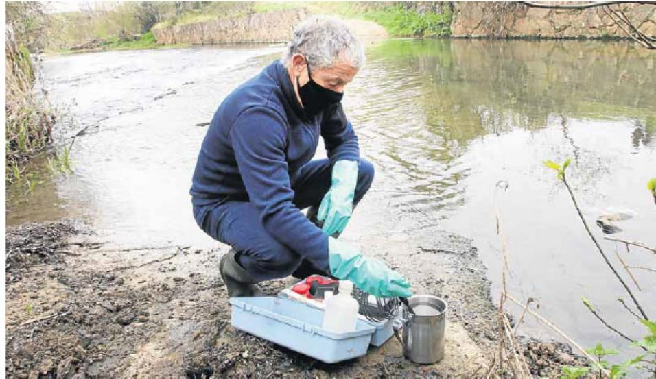
◀ Ricardo Fernández, a orillas del Nora, aplica una sonda multiparamétrica para conocer los primeros datos de una muestra tomada junto a la depuradora de Villapérez. FOTOS: JOSE VALLINA
