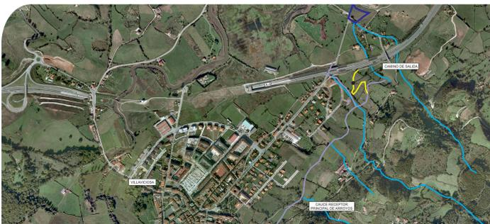
Trazado en planta del cauce de derivación y efectos de la entrada del agua en la red de saneamiento
