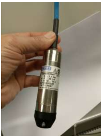
Foto de un instrumento de nivel presostático, que tiene una precisión inferior a 1 mm.
