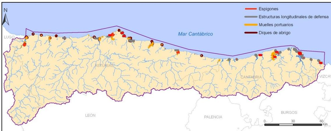
**Figura 13. Presiones alteraciones morfológicas en aguas de transición y costeras causadas por muelles portuarios, espigones y estructuras longitudinales de defensa**
