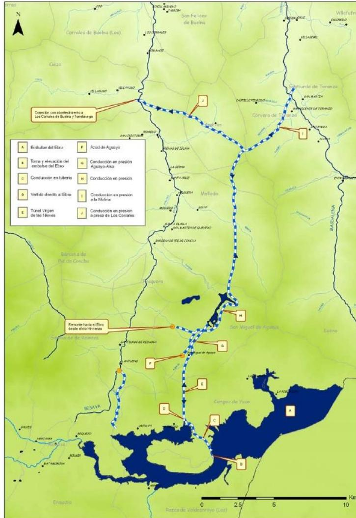
**Figura VI. 121. Esquema del trazado en planta del Bitrasvase Ebro-Pas-Besaya**
