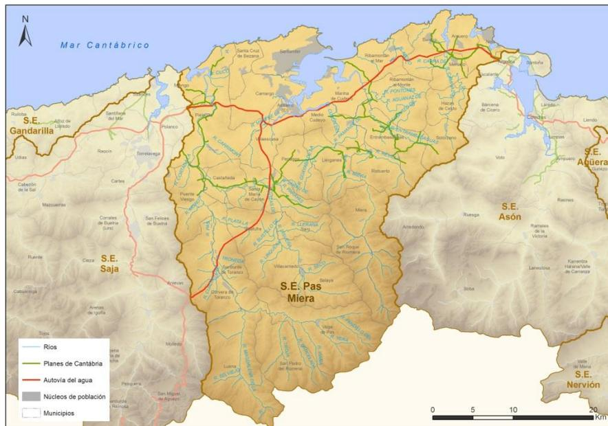
**Figura VI. 128. Conducciones de transporte más importantes del sistema Pas - Miera**
