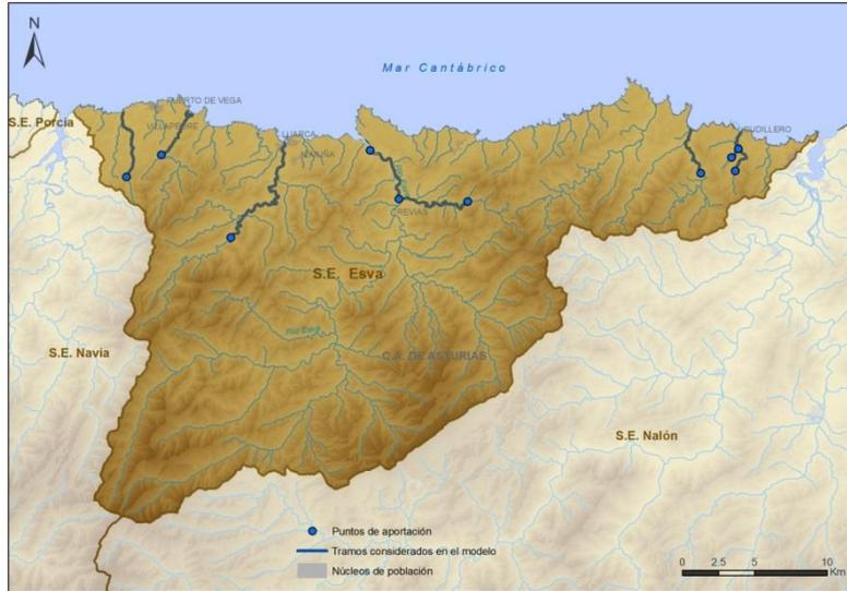
**Figura VI. 86. Red fluvial, puntos de aportación y tramos de río considerados en el modelo de simulación**
