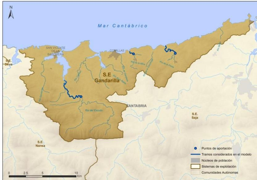
**Figura VI. 110. Red fluvial, puntos de aportación y tramos de río considerados en el modelo de simulación**
