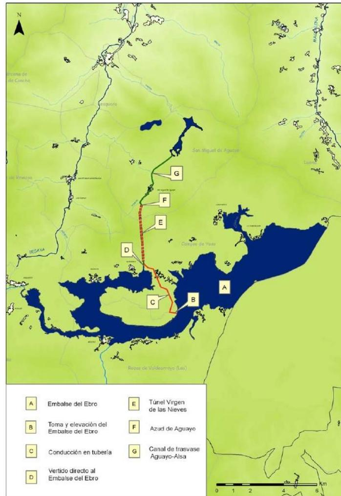
**Figura VI. 120. Esquema del trazado en planta del Bitrasvase de 1982**
