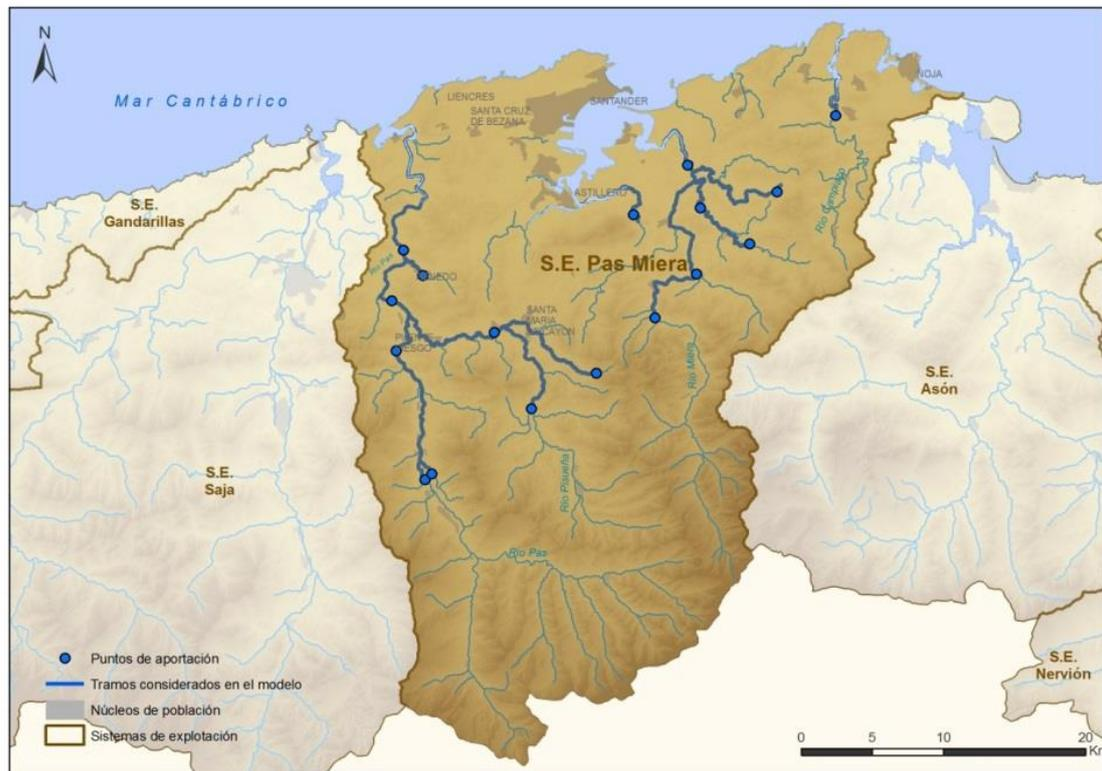
**Figura VI. 125. Red fluvial, puntos de aportación y tramos de río considerados en el modelo de simulación**
