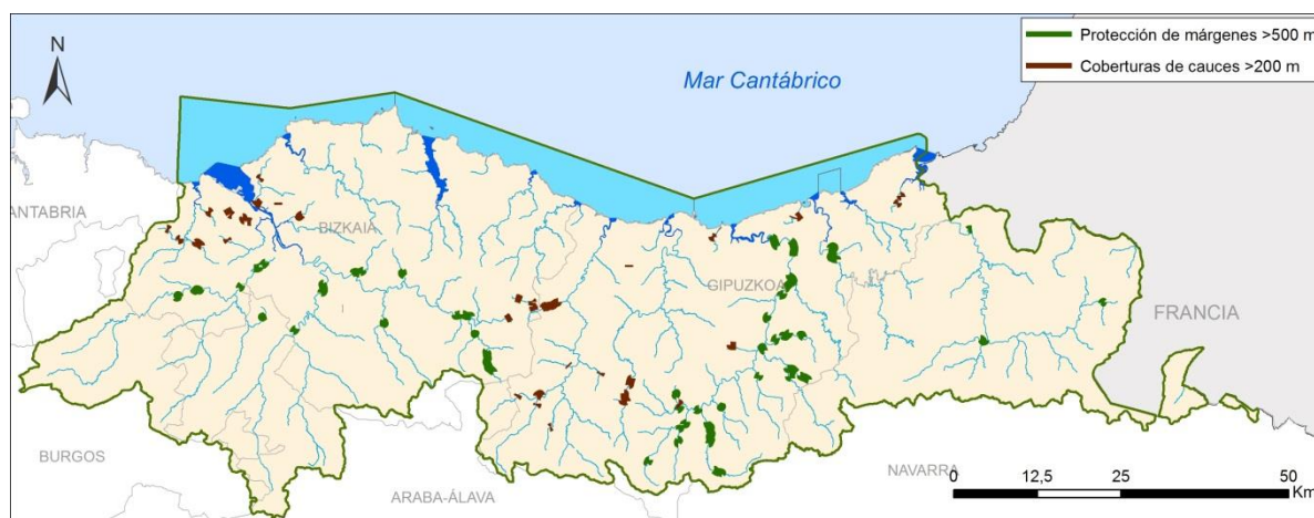
Figura 32 Coberturas de cauces y protecciones de márgenes
