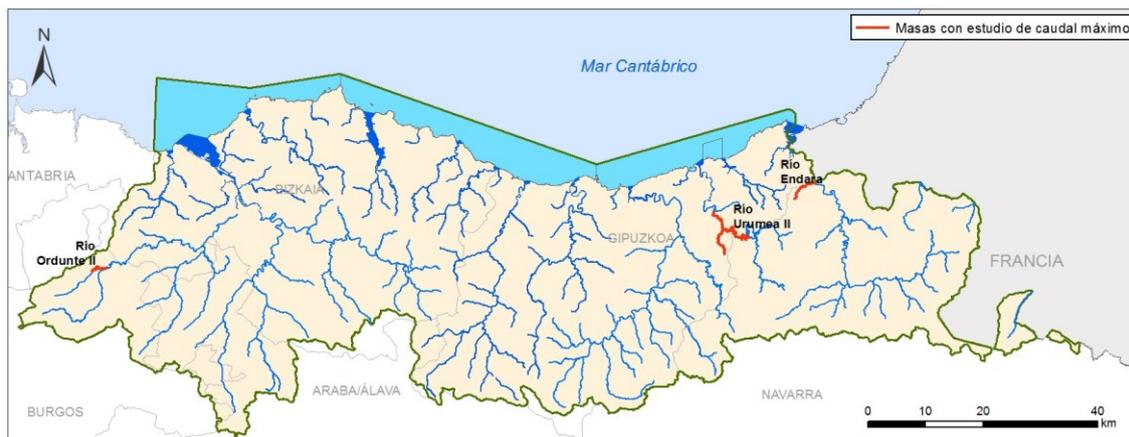
Figura 12 Masas en las que se han realizado estudios de caudales máximos en la DH del Cantábrico Oriental
