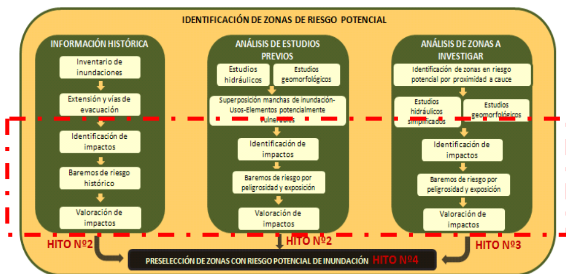
Fig.20.- Esquema metodológico de la identificación y valoración de zonas con riesgo potencial de inundación a partir de la Guía Metodológica para el desarrollo del Sistema Nacional de Cartografía de Zonas Inundables. Evaluación Preliminar del Riesgo (Borrador v5.0)
