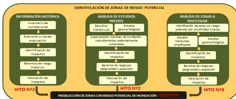
Fig.8.- Fase de identificación de las zonas de riesgo potencial, según la Guía Metodológica para el desarrollo del Sistema Nacional de Cartografía de Zonas Inundables. Evaluación Preliminar del Riesgo (Borrador v5.0)
