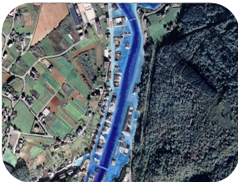
Delimitación hidráulica de la Zona Inundable (T500 años) del río Eo a su paso por Pontenova ( T.M. de A Pontenova).
